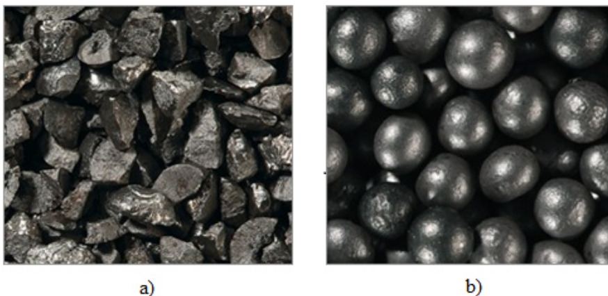
Slika 11. Sačma: a) lomljenog oblika i b) okruglog oblika [36]
