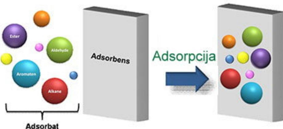
Slika 5. Princip adsorpcije [21]
