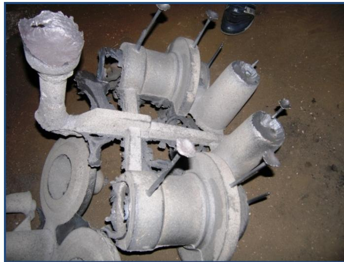
Slika 9. Izgled odljevka nakon vađenja iz jednokratnog kalupa
