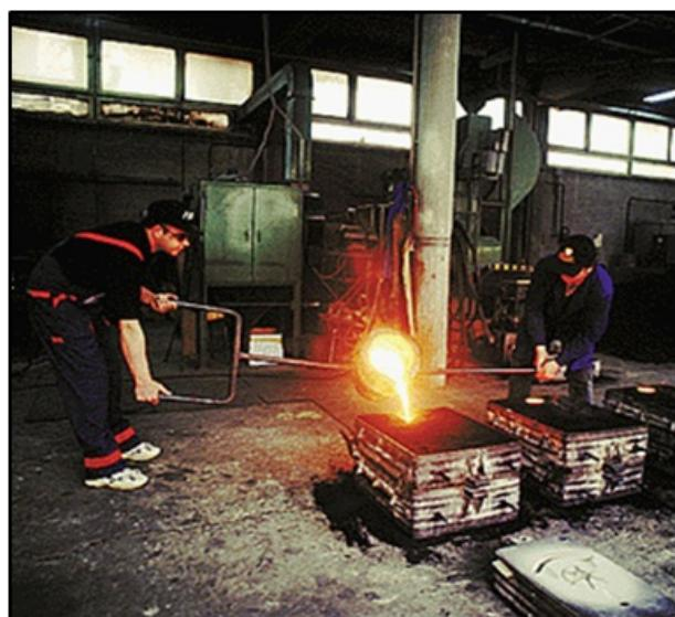
Slika 8. Ulijevanje taline u jednokratni kalup
