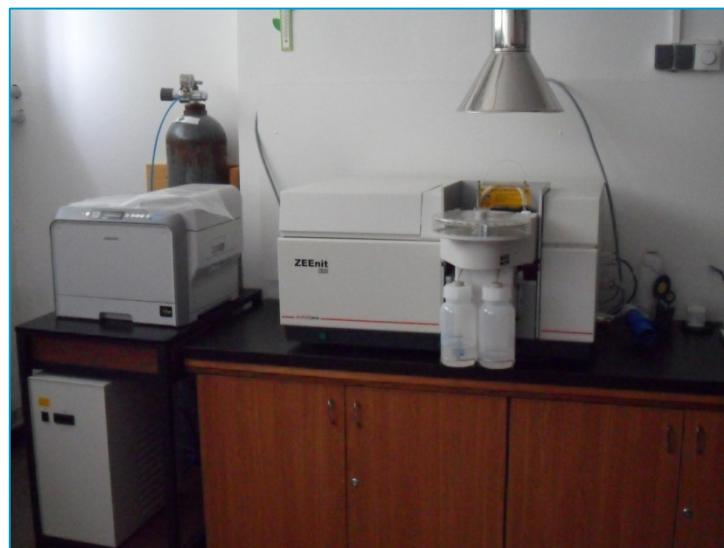
Slika 14. Atomski apsorpcijski spektrometar
