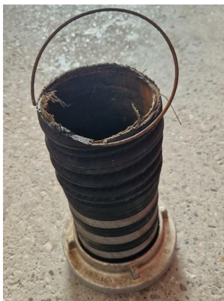
Slika 5. Presjek usisne cijevi
