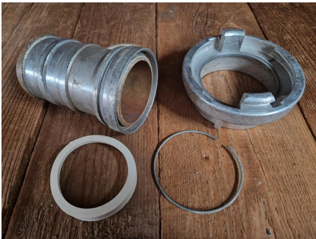
Slika 17. Sastavni dijelovi "Storz" vatrogasne spojnice
