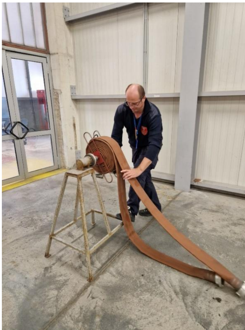
Slika 31. Uređaj za namatanje tlačnih cijevi
