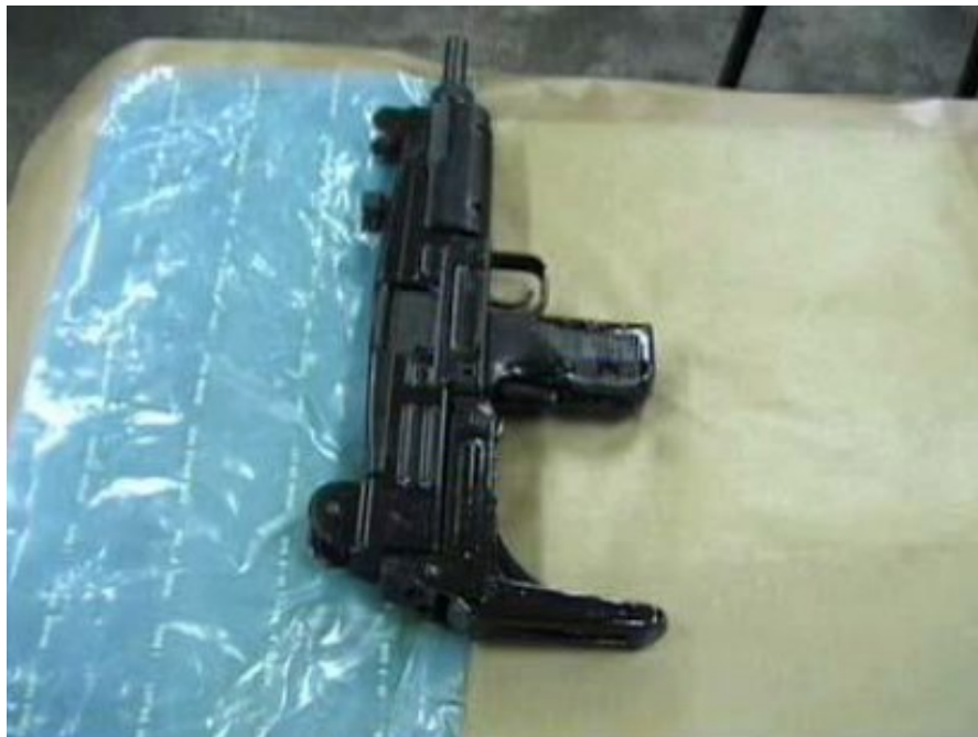
Slika 28. Folija impregnirana hlapljivim inhibitorom za zaštitu oružja [42]
