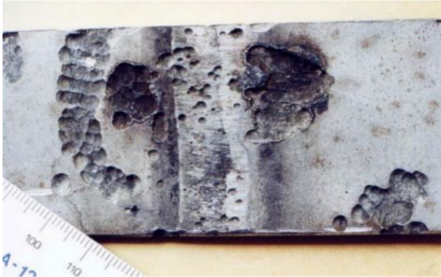
Slika 7. Pjegasta korozija čelika u morskoj vodi [12]
