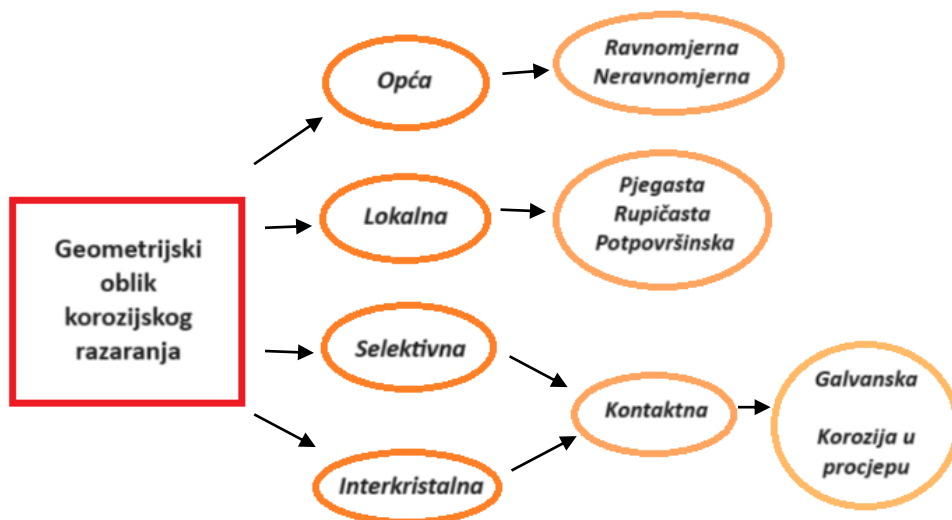
Slika 1. Klasifikacija prema geometrijskom obliku korozijskog razaranja
