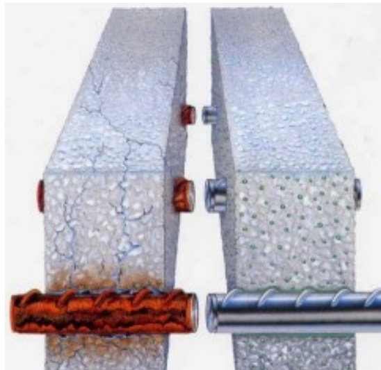
Slika 29. Migrirajući inhibitori u graditeljstvu [42]
