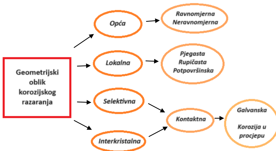
Slika 1. Klasifikacija prema geometrijskom obliku korozijskog razaranja
