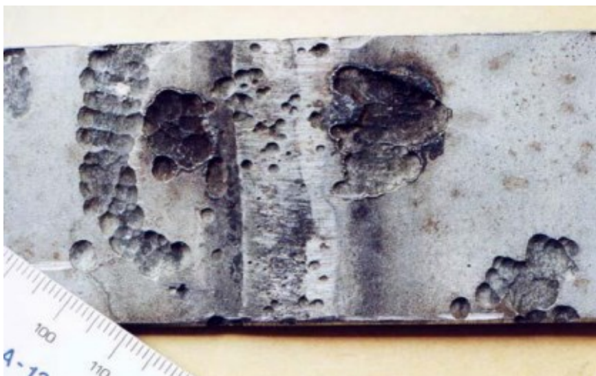
Slika 7. Pjegasta korozija čelika u morskoj vodi [12]
