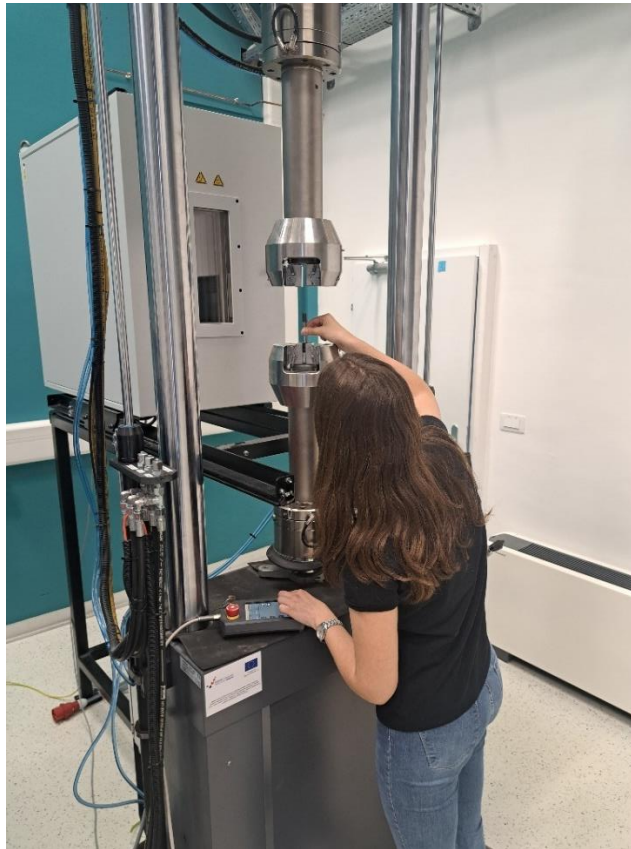
Slika 39 Radni položaj operatera pri postavljanju epruvete (slučaj 2)
