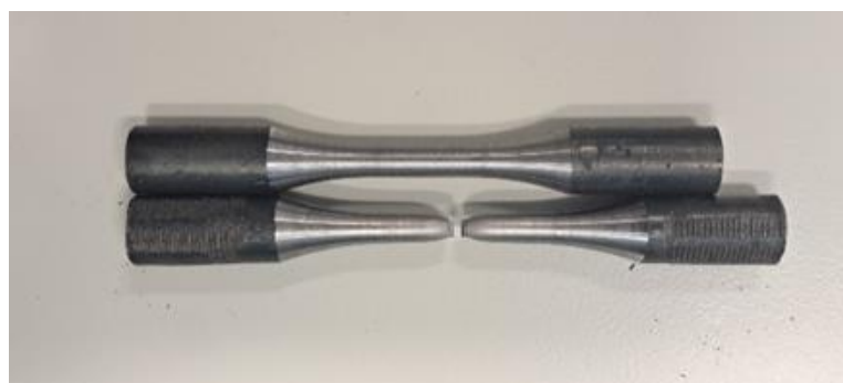
Slika 54 Epruvete prije i nakon izvedenog cikličkog testa
