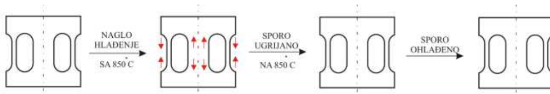
Slika 20. Shematski prikaz uklanjanja zaostalih naprezanja [35]
