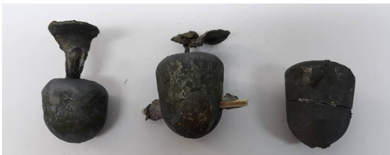
Slika 66. Pretaljeni uzorci alatnih čelika nakon provedene jednostavne toplinske analize
