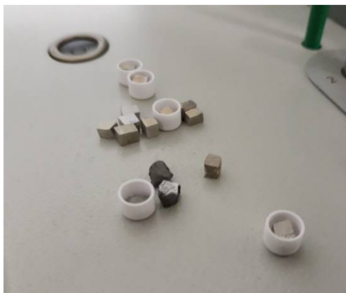
Slika 70. Izrezani uzorci za ispitivanje diferencijalnom pretražnom kalorimetrijom
