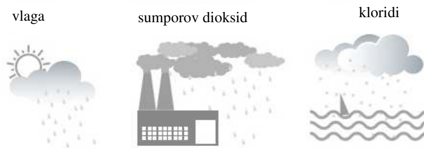
Slika 45. Čimbenici koji doprinose nastanku korozije [90]
