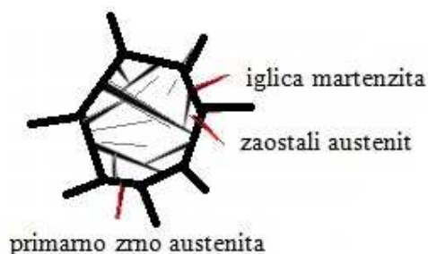
Slika 43. Rast iglica martenzita [5]
