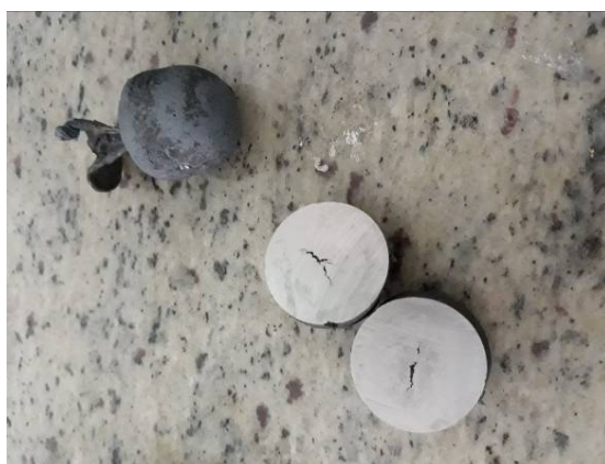
Slika 68. Primjer izrezanog ispitnog uzorka za potrebe provođenja rendgenske fluorescentne analize
