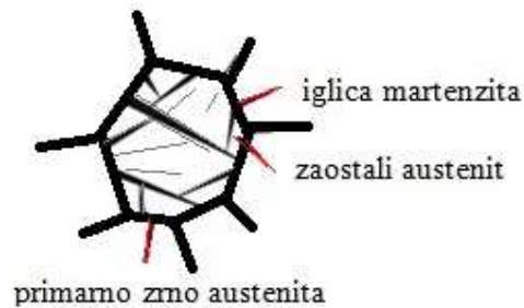
Slika 43. Rast iglica martenzita [5]
