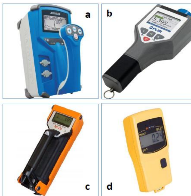
Slika 1. Neki od tipova prijenosnih uređaja za utvrđivanje radioaktivnih tvari u čeličnom otpadu; a) AT6102A Spectrometer, ATOMTEX, Bjelorusija; b) identiFINDER R400, FLIR Systems, SAD; c) ASHKA RS 125 Super SPEC Handheld Gamma Ray Spectrometer, Indija; d) RADTRONICS, RDS – 30 Radiation Survey Meter, Australia [31-34]
