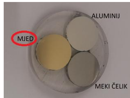
Slika 5. Izrezani i zaliveni uzorci
