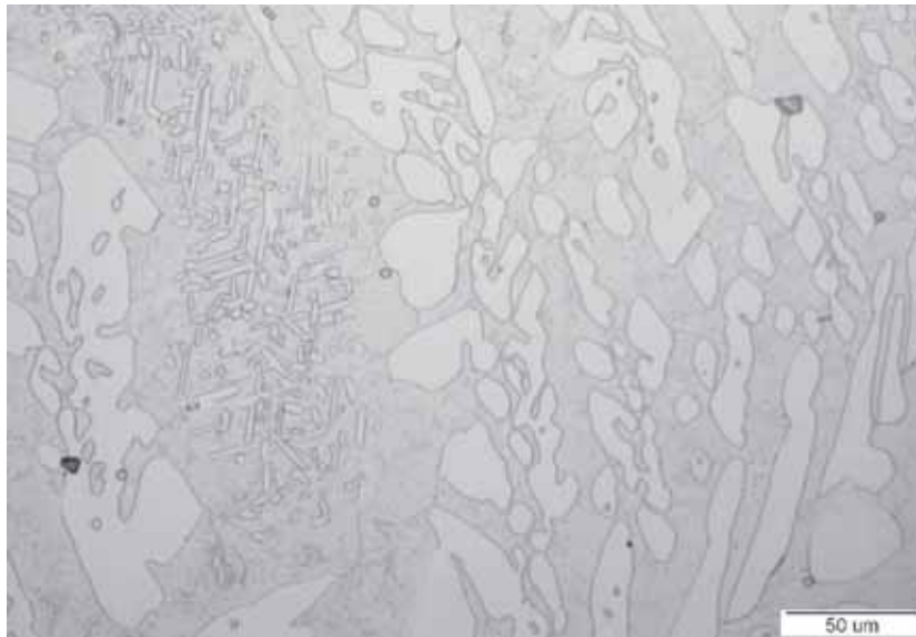
Slika 4. Mikrostruktura dupleks nehrđajućeg čeličnog lijeva GX2CrNiMoN25-6-3
