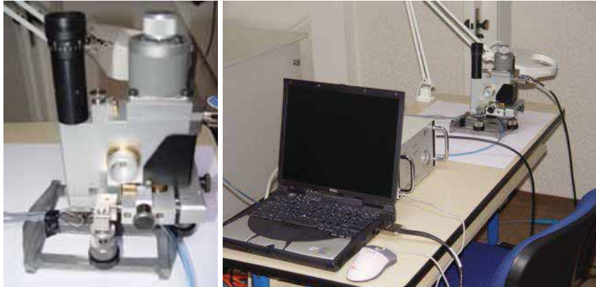
Slika 8. Mjerenje zaostalih naprezanja na rešetkastoj probi uređajem MTS 3000
