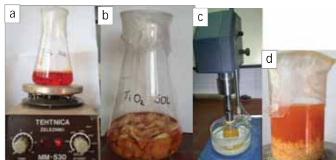
Slika 3. a) TiO 2 sol, b) infiltracija TiO 2 sola na membrane ljuske jaja, c) sonokemijsko tretiranje sonotrodom, d) nakon tretiranja sonotrodom
