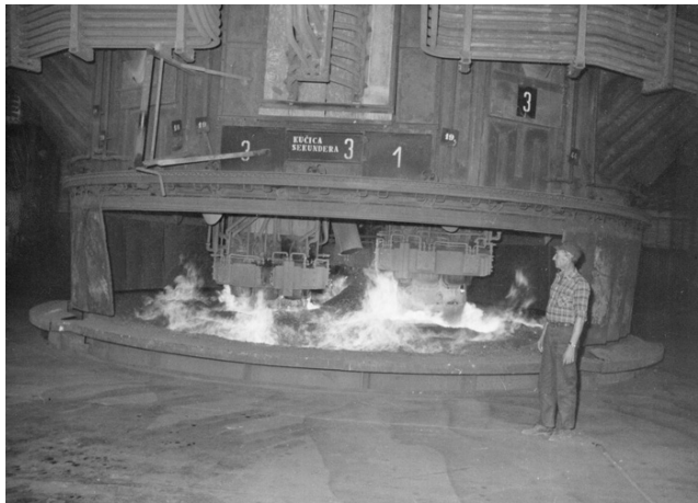
Gornji sloj peći za proizvodnju ferolegura, Tvornica karbida i ferolegura Dalmacija – Dugi Rat, druga polovica XX. st.
