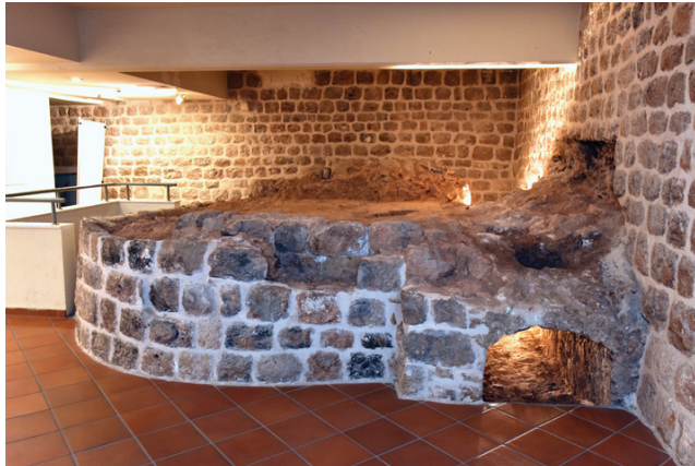
Peć Ivana Krstitelja Rabljanina za lijevanje topova i zvona u tvrđavi Revelinu, početak XVI.st., Dubrovački muzeji, Arheološki muzej
