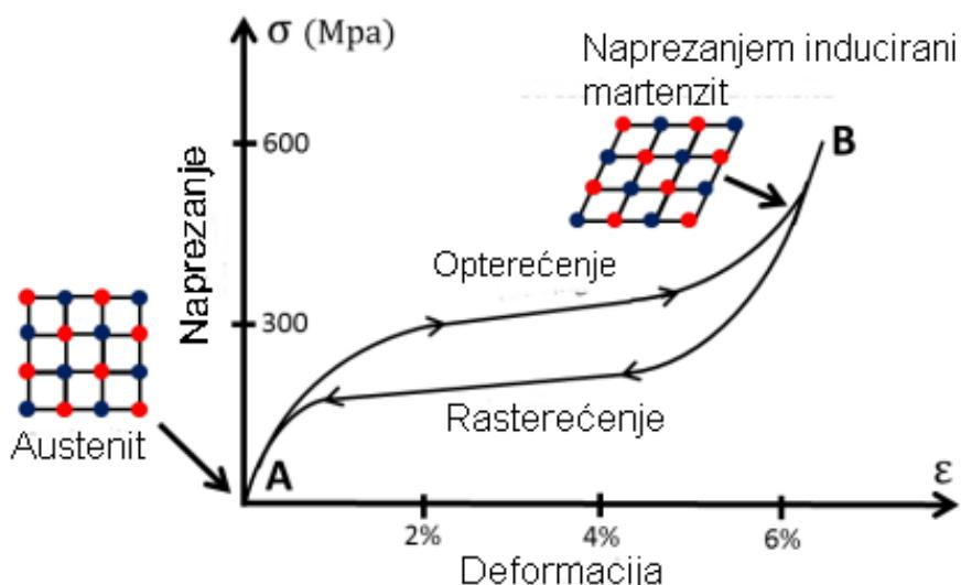
Slika 8. Superelastično ponašanje legura s efektom prisjetljivosti oblika na dijagramu naprezanje-deformacija [13]
