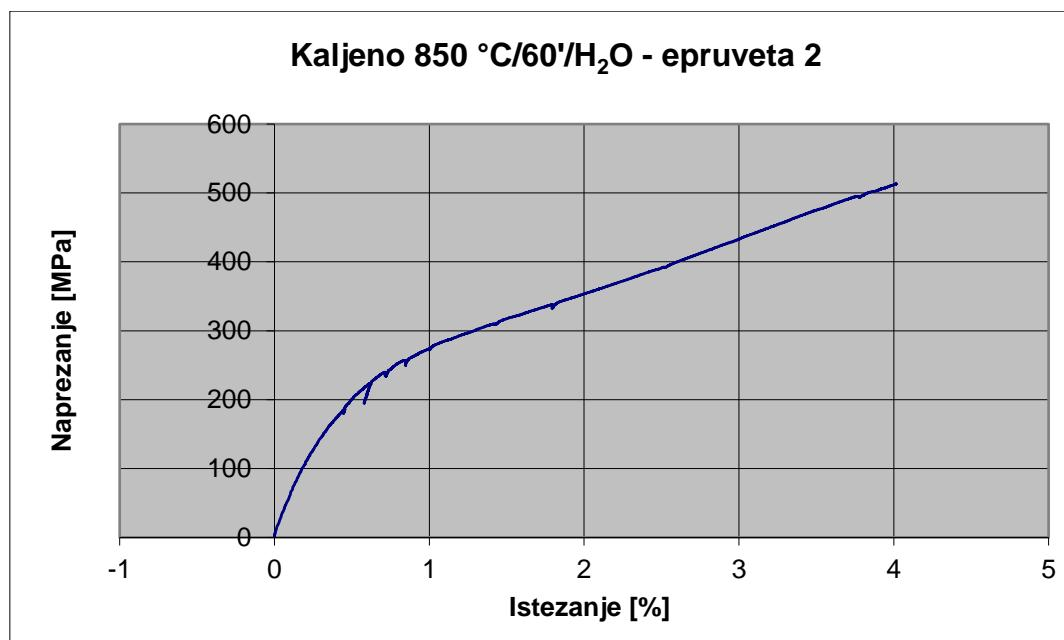
Slika 40. Dijagram naprezanje – istezanje za kaljeni uzorak
