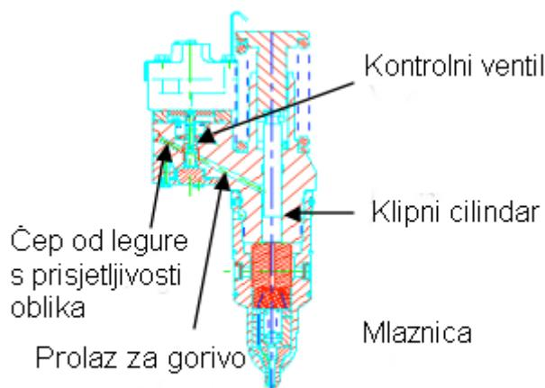
Slika 12. Tipična konstrukcija dizelovog injektora za gorivo [16]
