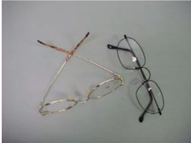
Slika 16. Okviri za naočale izrađene od legure s prisjetljivosti oblika [16]
