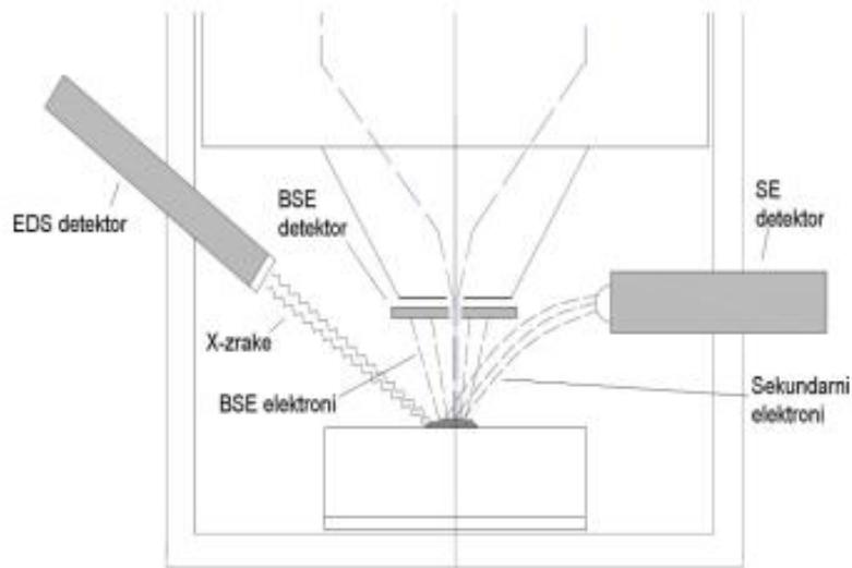
Slika 32. Shematski prikaz tri osnovne vrste detektora [24]
