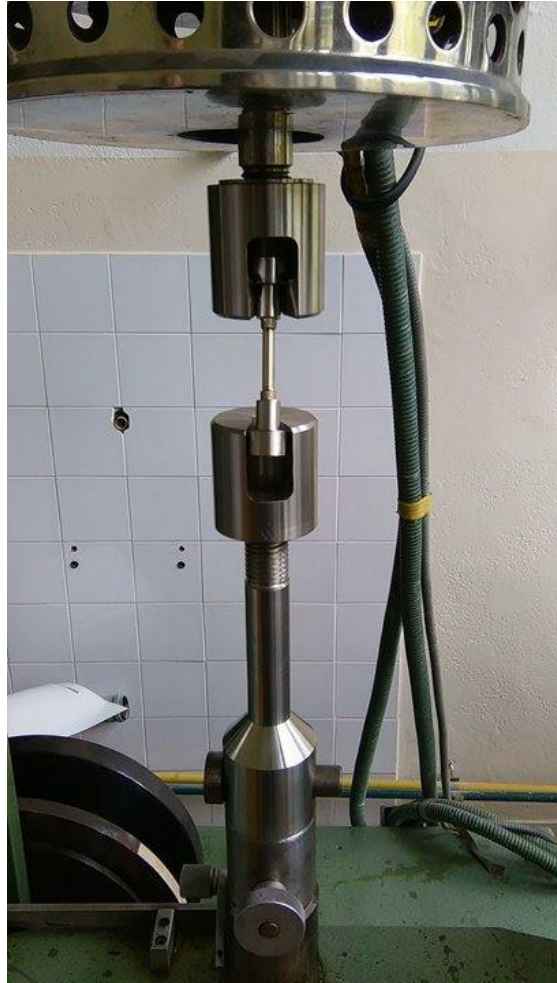
Slika 29. Uzorak pri statičkom vlačnom pokusu
