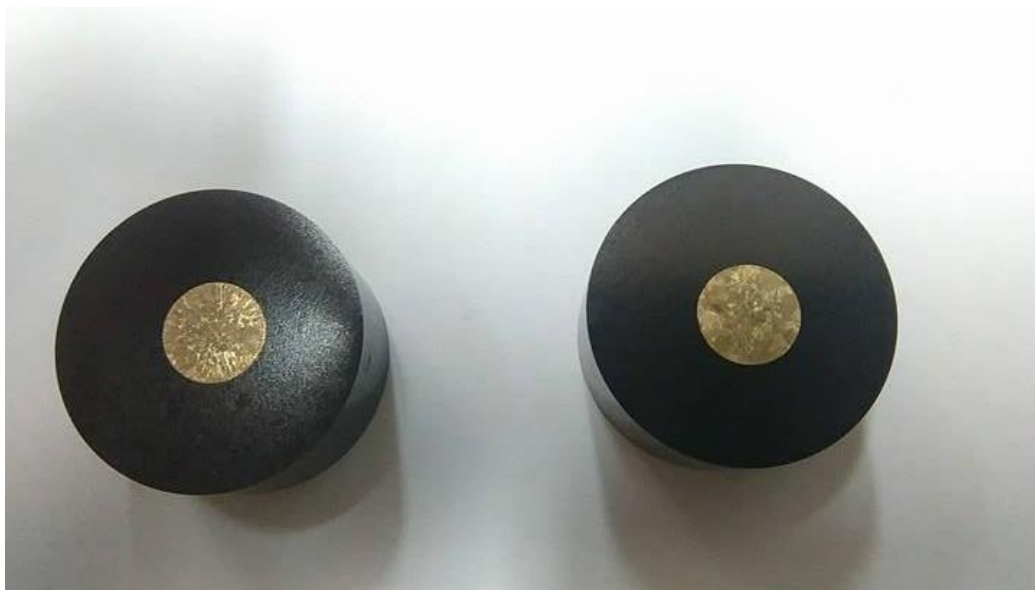
Slika 23. Fotografije uzoraka nakon nagrizanja
