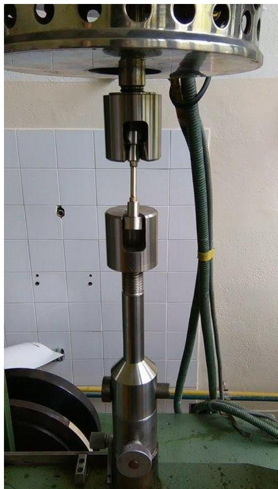
Slika 29. Uzorak pri statičkom vlačnom pokusu
