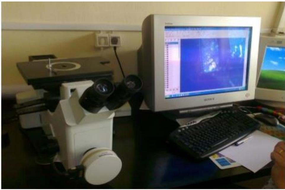
Slika 30. Fotografija svjetlosnog mikroskopa Olympus GX51
