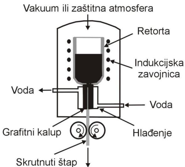
Slika 19. Lijevanje slitine CuAlNi tehnologijom vertikalnog lijevanja [14]
