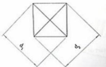
Slika 24. Otisak pri mjerenu tvrdoće po Vickersovoj metodi [18]
