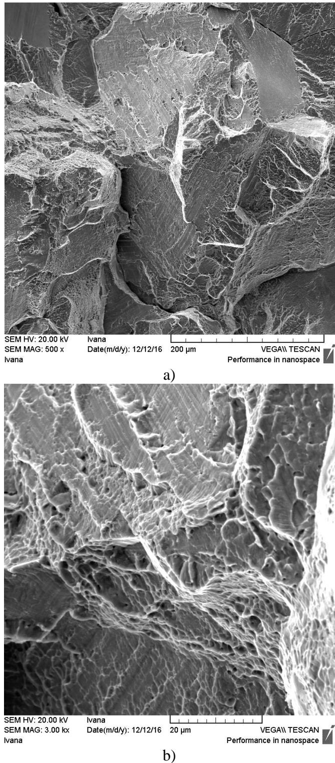
Slika 43. SEM mikrofotografske snimke prijelomne površine CuAlNi legure u kaljenom stanju pri povećanjima; 500x - a i 3000x – b, pozicija 1
