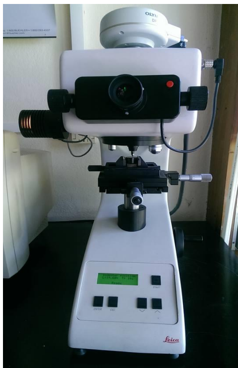
Slika 25. Fotografija tvrdomjera Leica VHMT
