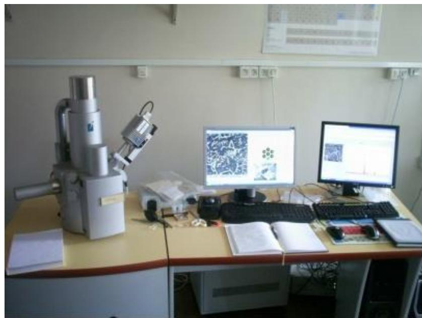
Slika 31. Fotografija pretražnog elektronskog mikroskopa Tescan Vega TS 5136
