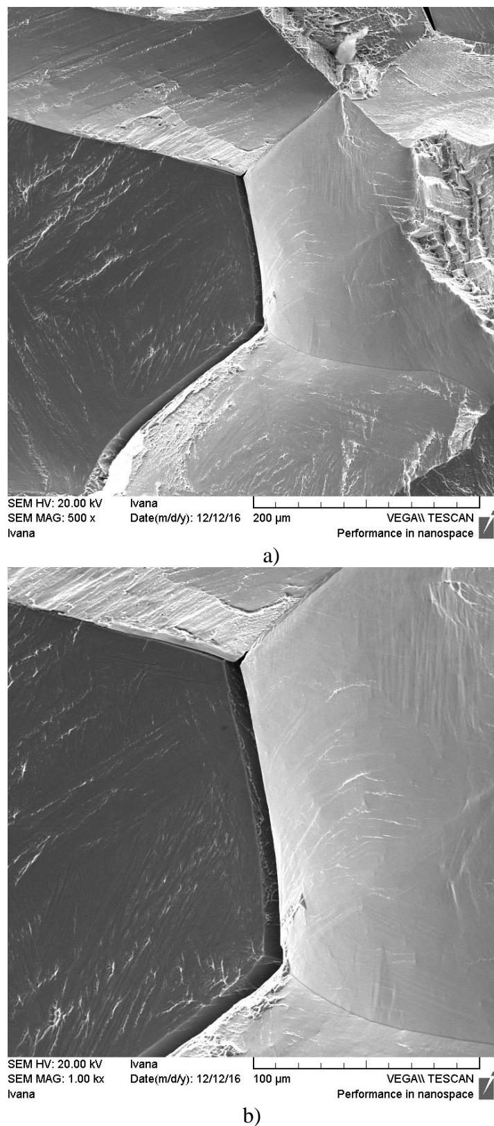
Slika 44. SEM mikrofotografske snimke prijelomne površine CuAlNi legure u kaljenom stanju pri povećanjima; 500x - a i 1000x – b, pozicija 2
