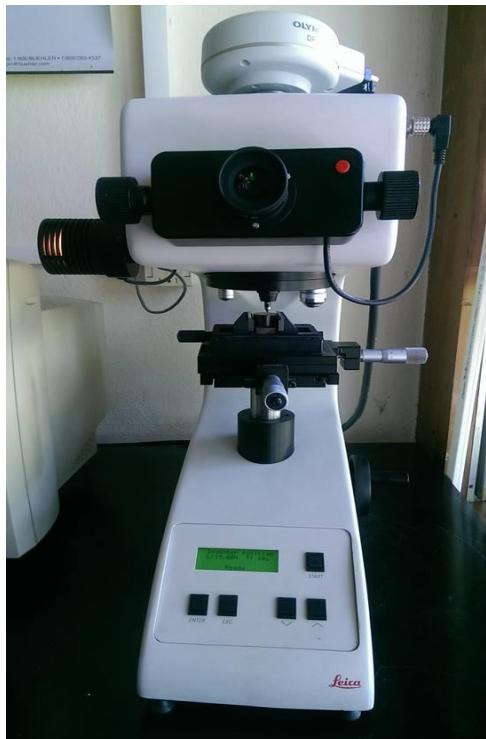
Slika 25. Fotografija tvrdomjera Leica VHMT
