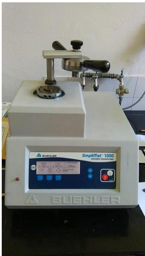
Slika 20. Fotografija uređaja za ulaganje uzorka u vodljivu masu Buehler Simplimet 1000
