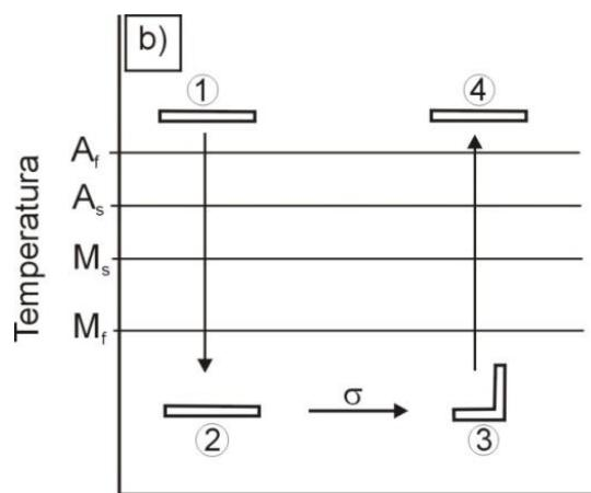
Slika 5. Shema jednosmjernog efekta prisjetljivosti oblika [2]
