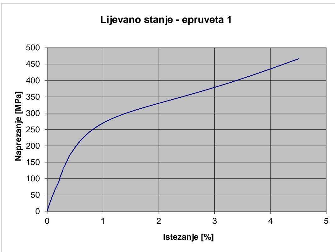
Slika 39. Dijagram naprezanje – istezanje za uzorak lijevanog stanja
