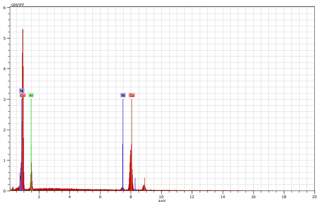
Slika 36. SEM mikrofotografija CuAlNi legure s prisjetljivosti oblika u lijevanom stanju (a) i EDS spektar pozicije 1 (b)
