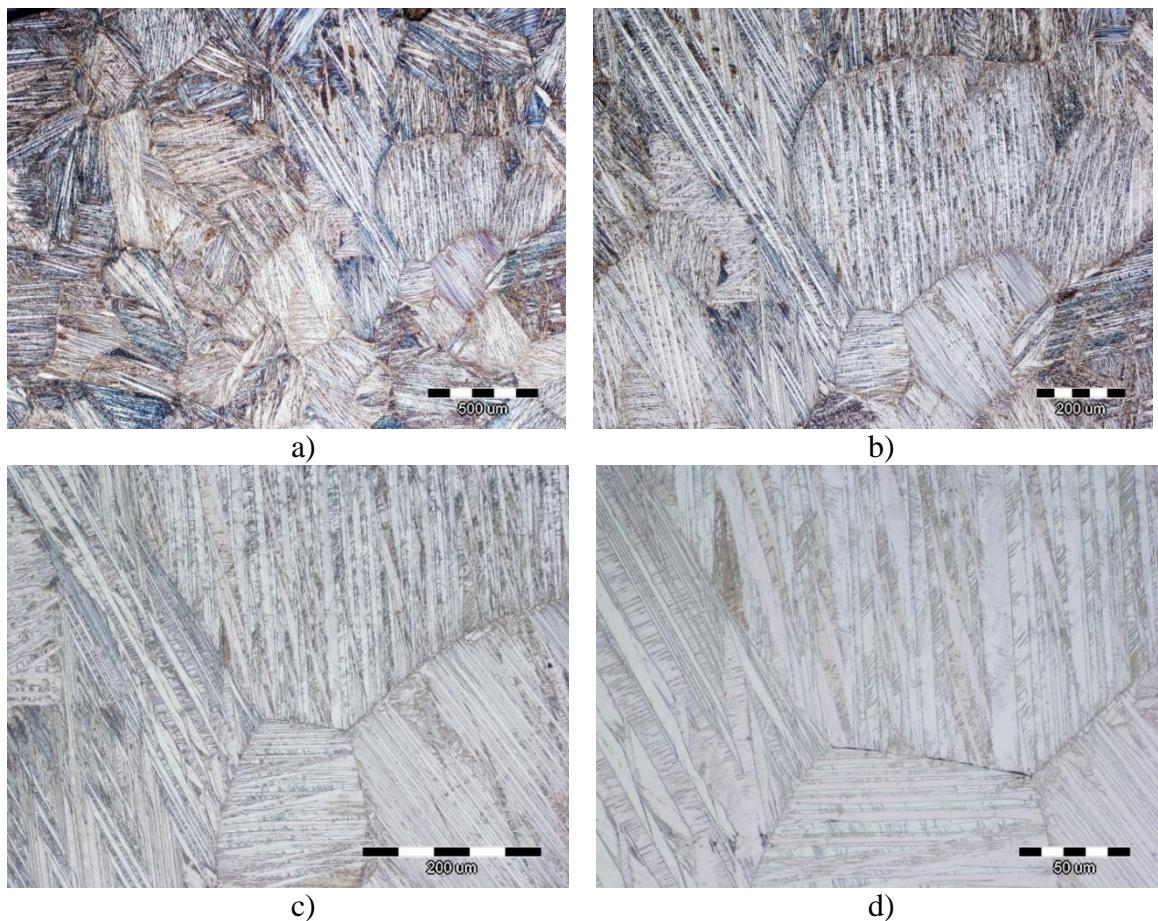
Slika 34. Optičke mikrofotografije CuAlNi legure s prisjetljivosti oblika u kaljenom stanju pri različitim povećanjima; a – 50x, b – 100x, c – 200x i d – 500x
