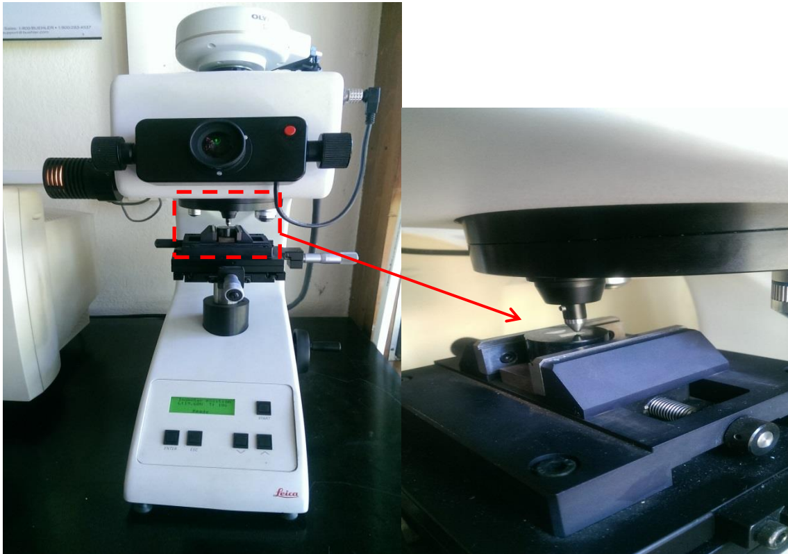
Slika 27. Fotografije tvrdomjera Leica korištenog za ispitivanje tvrdoće
