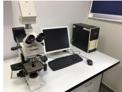
Fig. 2 Light microscope Leica DM 2500 M.
