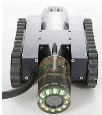
Рис. 2. Гусеничный робот-контроллер NanoMag [2].
