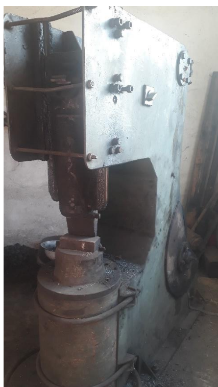
Slika 26. Korišten kovački stroj (mehanički polužni perni bat)
