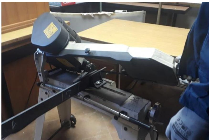
Slika 29. Rezanje uzorka tračnom pilom
