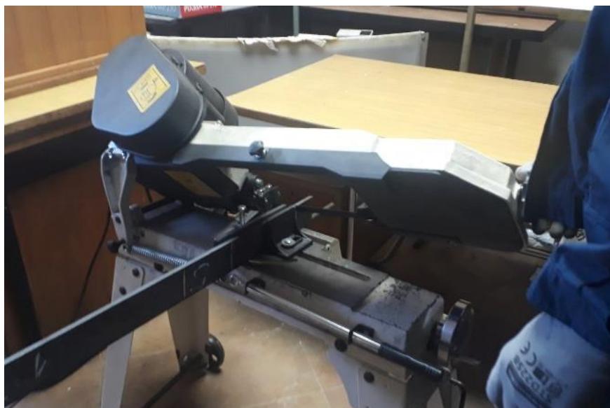
Slika 29. Rezanje uzoraka tračnom pilom
