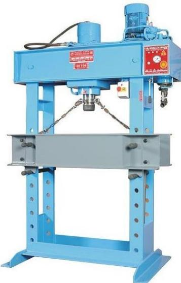
Slika 9. Hidraulična preša [14]
