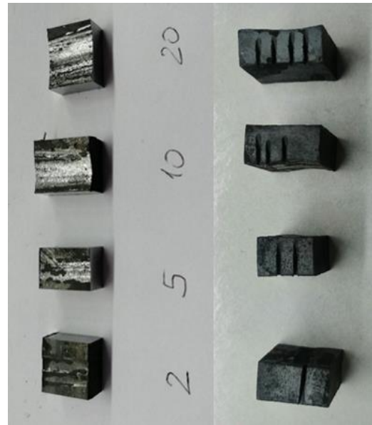
Slika 33. Izrezani uzorci: lijevi stupac za analizu i desni stupac za toplinsku obradu
