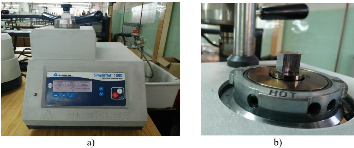
Slika 36. a) uređaj za vruće izostatsko prešanje (Buehler SimpliMet 1000),
