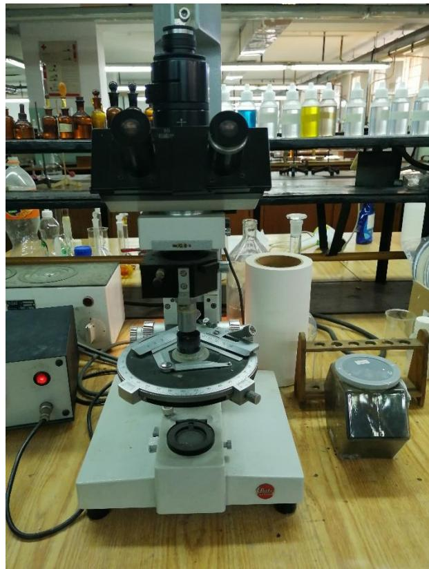
Slika 40. Metalografski svjetlosni mikroskop Leica Ortholux
