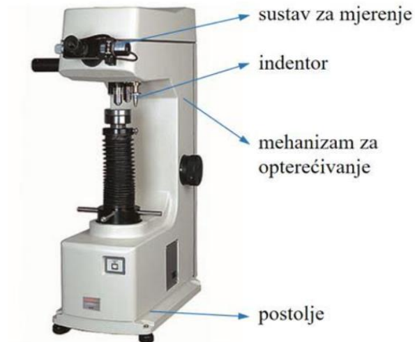
Slika 23. Tvrdomjer i njegove komponente [25]
