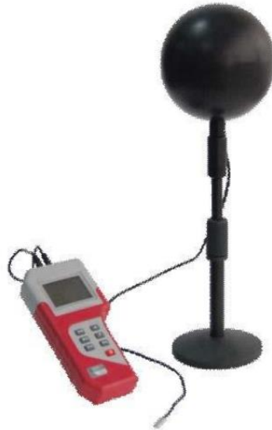
Slika 5. Globus termometar za mjerenje temperature zračenja plohe [11]
