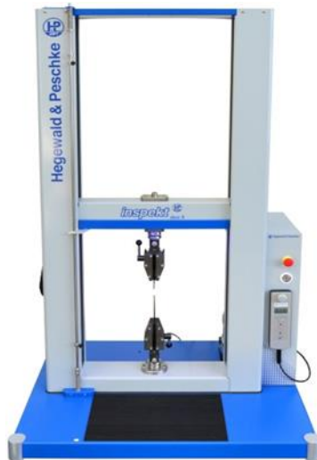
Slika 6. Kidalica za statička ispitivanja do 100 kN [13]
