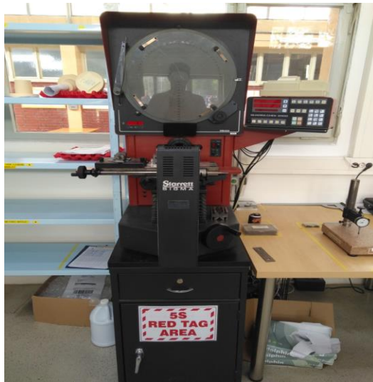
Slika 6. Optički komparator Starret Sigma HB400
