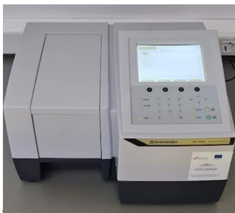
Slika 5. i 6. Spektrofotometrijsko određivanje koncentracije gorčine Figures 5. and 6. Spectrophotometric determination of bitterness concentration
