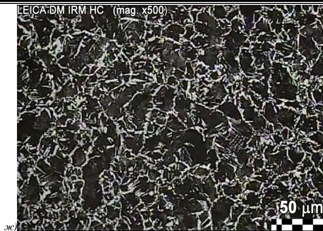
Рис 3 Микроструктура стали марки 45: а – исходная структура; б, в – после деформирования в ступенчато-клиновых бойках новой конструкции; г, д - после деформирования в ступенчато-клиновых бойках старой конструкции; е, ж – после деформирования в ступенчатых бойках; (б, г, е - в продольном направлении; в, д, ж - в поперечном направлении)
