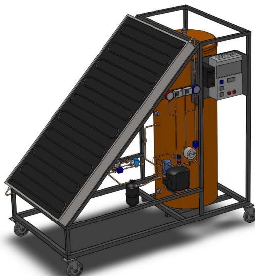
Slika 17. Prototip mobilne solarne dizalice topline s direktnim isparavanjem radne tvari [25]
