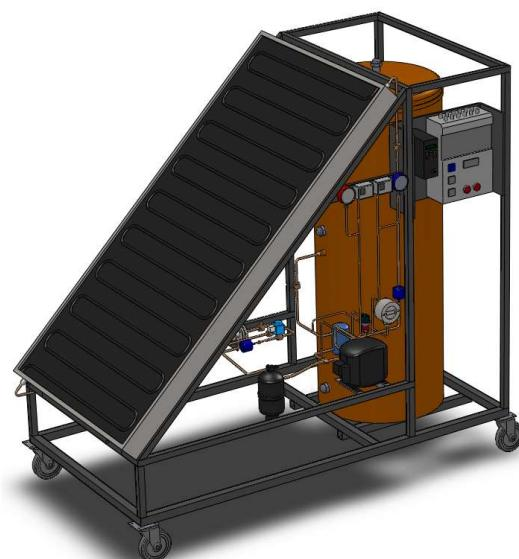
Slika 17. Prototip mobilne solarne dizalice topline s direktnim isparavanjem radne tvari [25]
