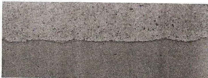
*Slika 10. Područje zavara trenjem između aluminija (gore) i ugljičnog čelika (dolje) [20]*
