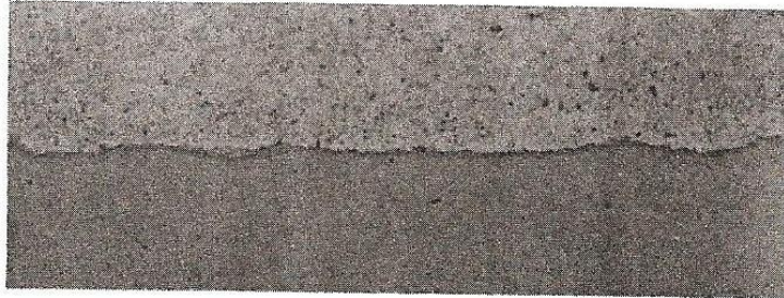
Slika 10. Područje zavora trenjem između aluminija (gore) i ugljičnog čelika (dolje) [20]
