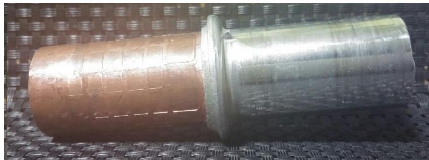
*Slika 13. Spojnica Cu/Al*
