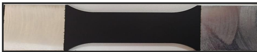
Slika 25. Epruveta s nanesenim crnim mat premazom
