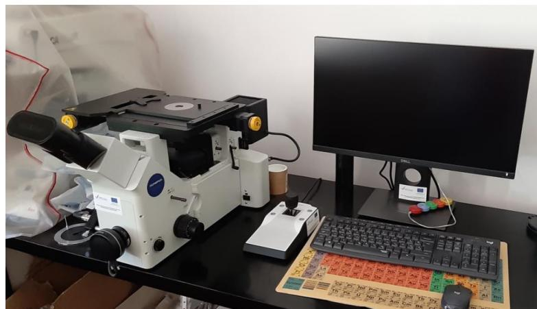
Slika 27. Invertni metalografski mikroskop Olyimpus GX51 s digitalnom kamerom DP70
