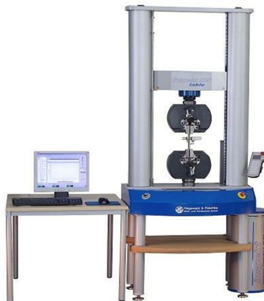
Slika 31. Statička kidalica Inspekt table 100 kN
