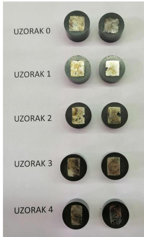
Slika 21. Uzorci nakon prešanja u vodljivu masu
