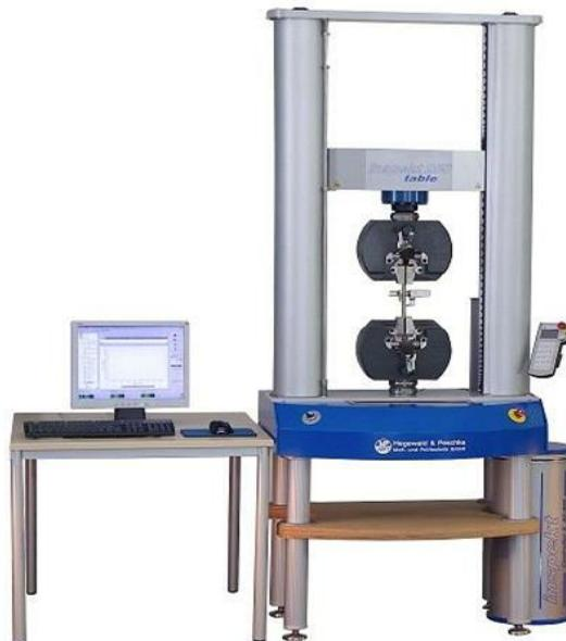
Slika 31. Statička kidalica Inspekt table 100 kN
