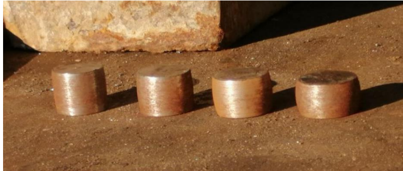
Slika 16. Uzorci nakon sabijanja
