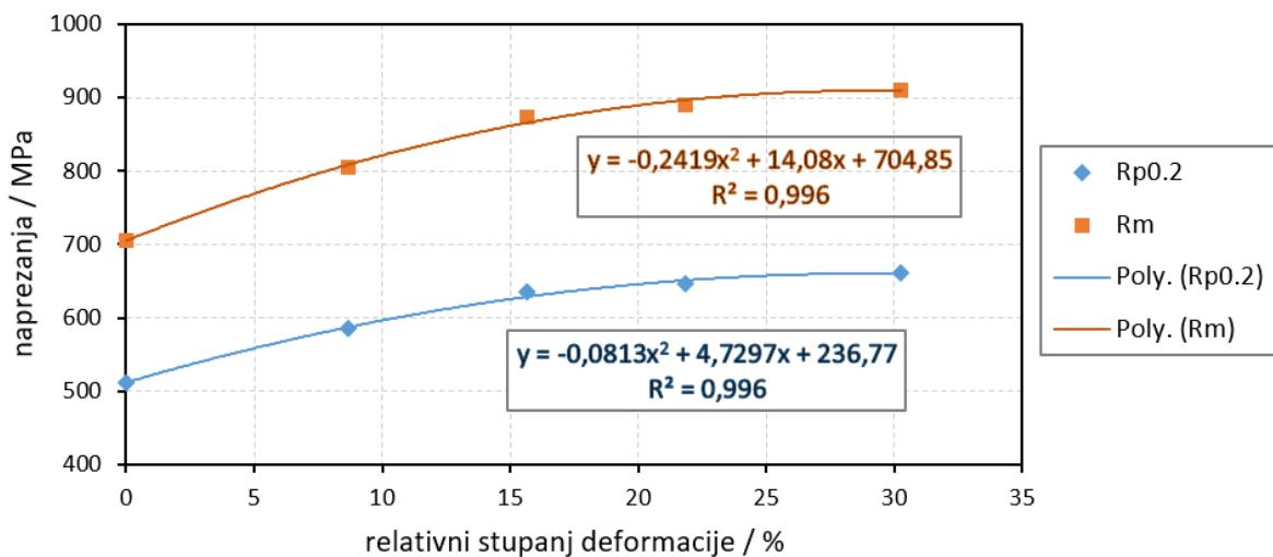
Slika 65. Ovisnost graničnih naprezanja ( $R_m$  i  $R_{p0.2}$ ), izračunatih pomoću izmjerene tvrdoće o stupnju deformacije
