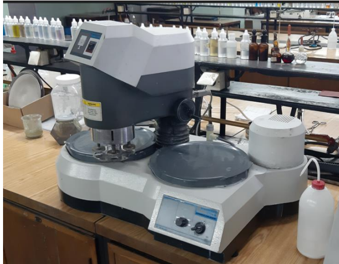
Slika 22. Uređaj za brušenje i poliranje "BUEHLER Phoenix Beta"
