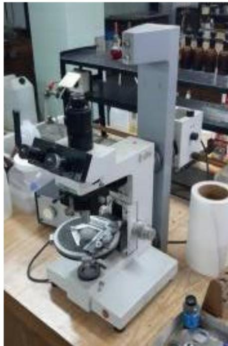
Slika 24. Metalografski svjetlosni mikroskop Leica Ortholux
