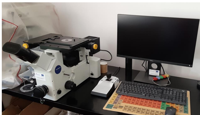
Slika 27. Invertni metalografski mikroskop Olympus GX51 s digitalnom kamerom DP70
