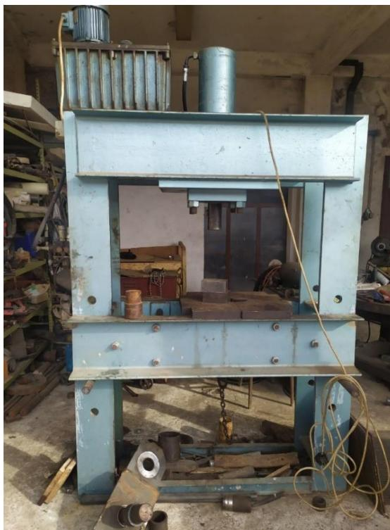
Slika 14. Korištena hidraulična preša
