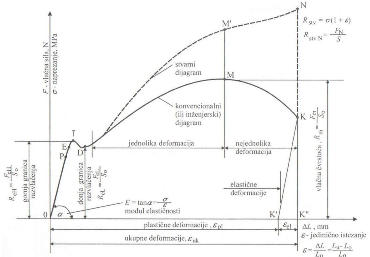
Slika 6. Dijagram  $F-\Delta L$  i  $\sigma-\varepsilon$  za niskougljični čelik [11]
