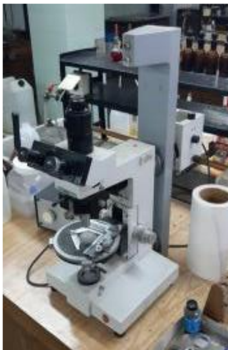
Slika 24. Metalografski svjetlosni mikroskop Leica Ortholux
