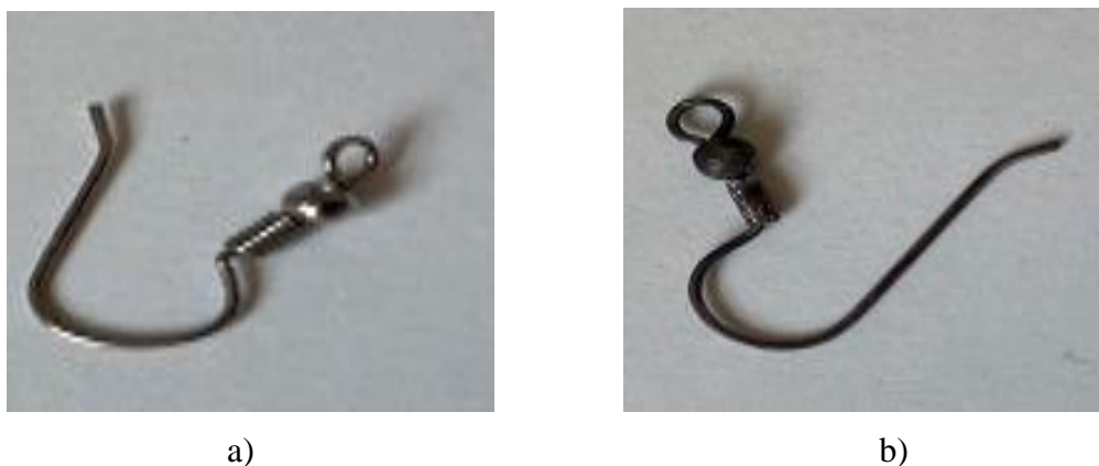
Slika 20. Izgled nakita (kukica na kojima vise naušnice) koji je tijekom nošenja u potpunosti u kontaktu s kožom: a) prije kontakta s modelnom otopinom, b) nakon 2 sata kontakta s modelnom otopinom
