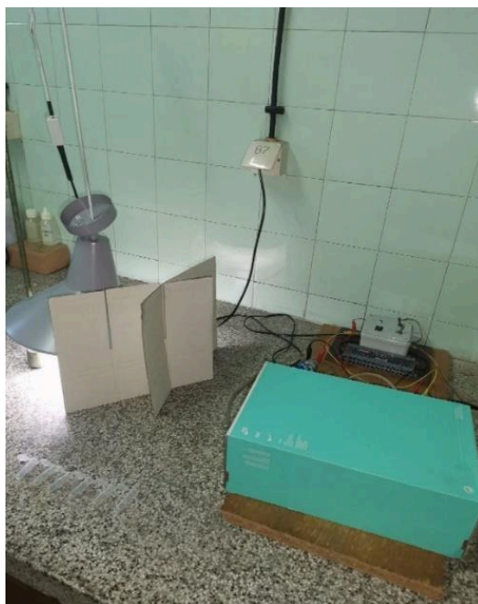
Slika 20. Ispitivanje fotokatalitičkih svojstava bez djelovanja svjetlosti.
