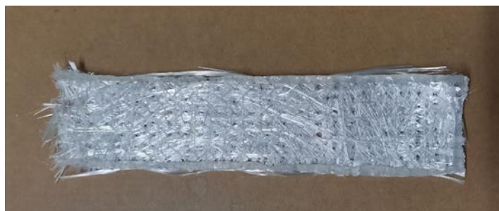
Slika 14. Silikon postavljen na rubove trake staklene mrežice.
