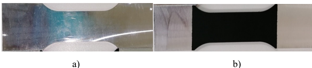
Slika 26. Prikaz ispitnih uzoraka za ispitivanje a) bez premaza i b) s crnim mat premazom
