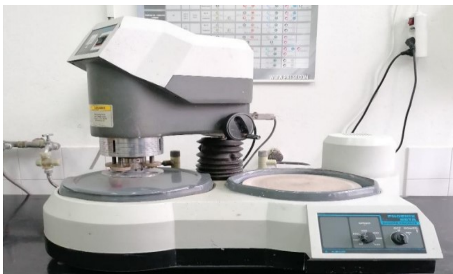
Slika 35. Fotografija uređaja za brušenje i poliranje PHOENIX BETA GRINDING/POLISHER
