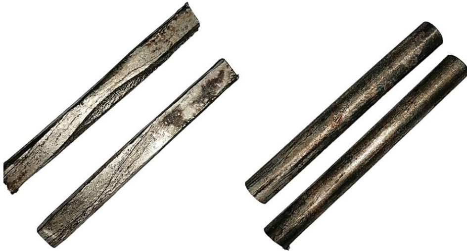
Slika 22. Uzorci CuAlMn legure nakon toplinske obrade
