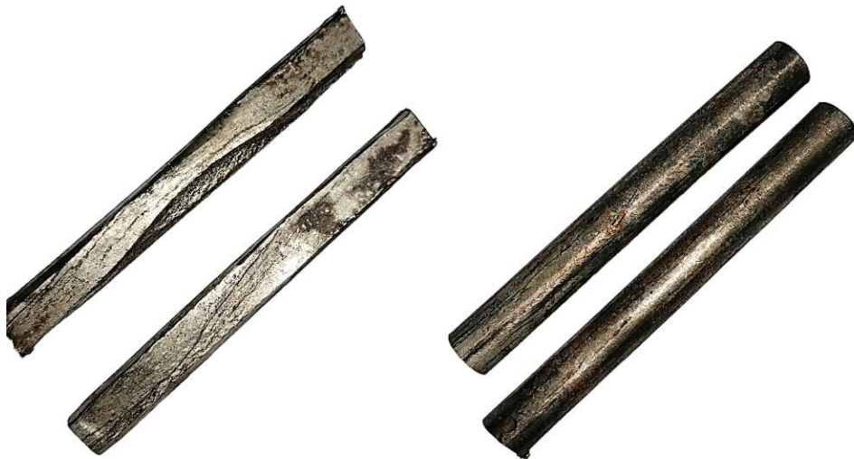
Slika 22. Uzorci CuAlMn legure nakon toplinske obrade
