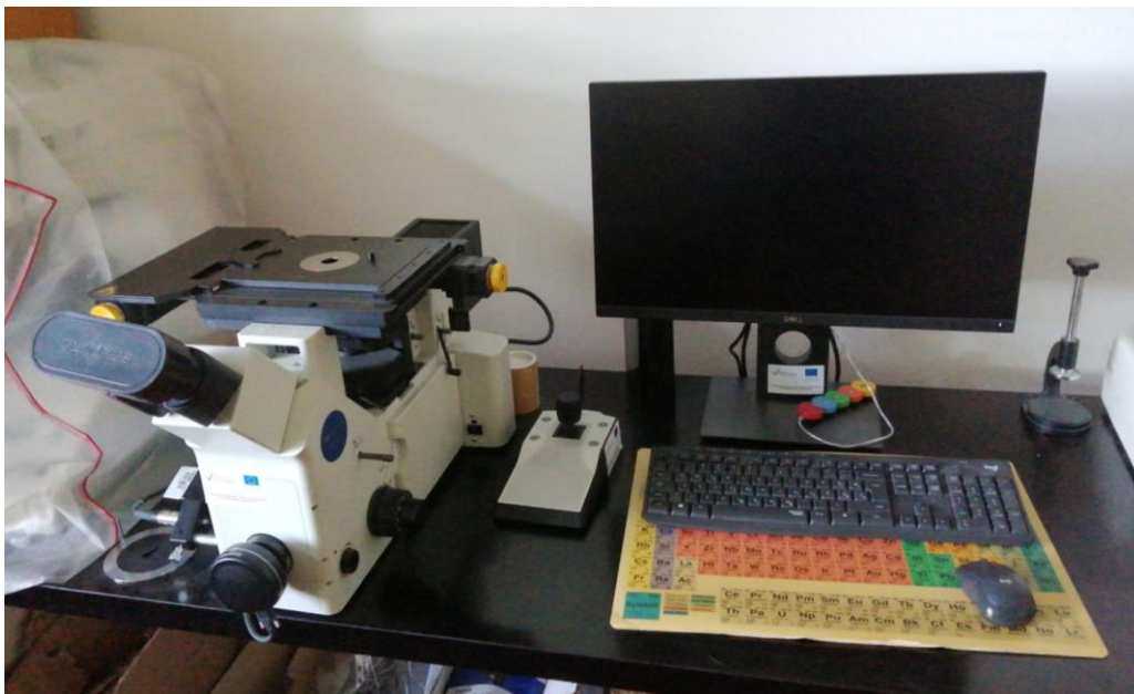
Slika 27. Svjetlosni mikroskop Olympus GX51
