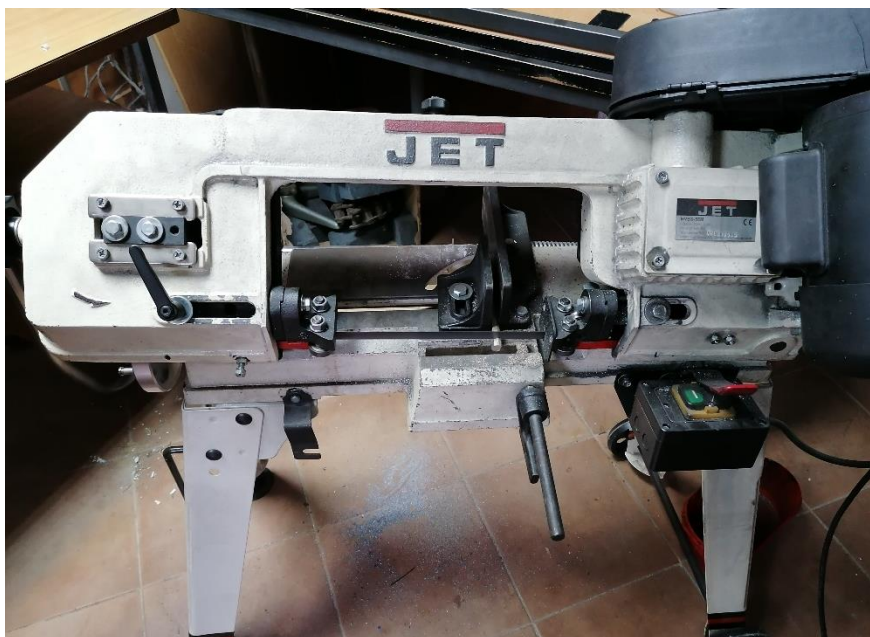
Slika 23. Prikaz JET rezalice uzoraka CuAlMn legure
