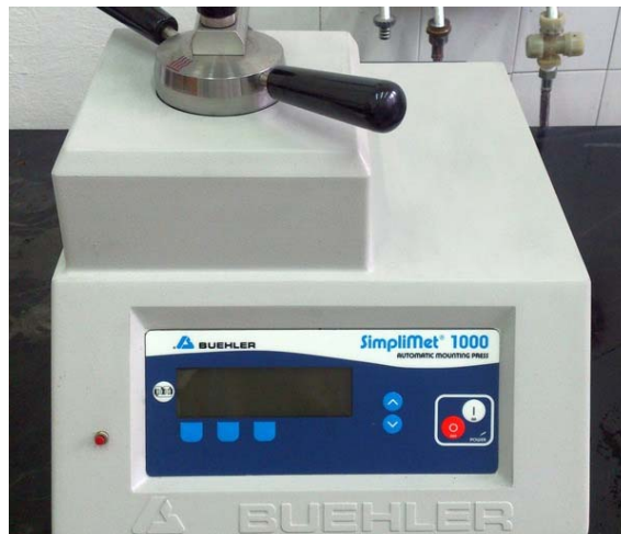
Slika 14. Uređaj SimpliMet 1000 za toplo „prešanje“ uzoraka (metalografska priprema)
