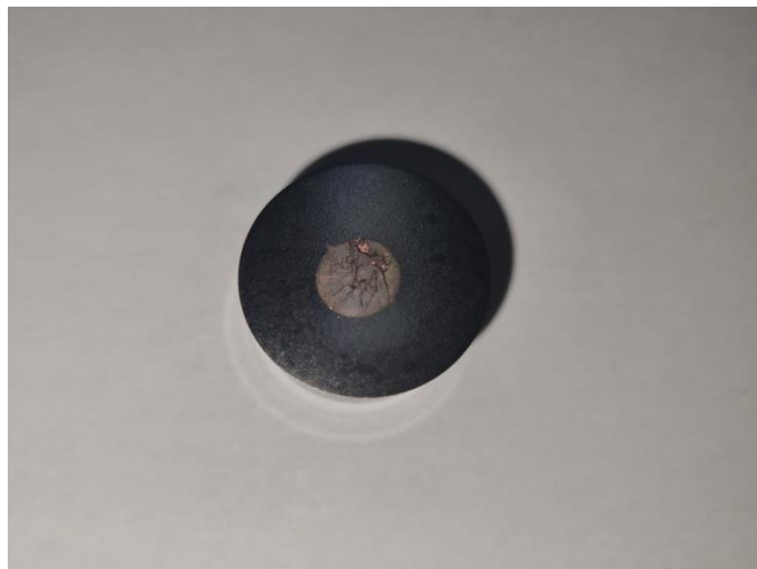
Slika 9. Uzorak 50Cu-50Zr legure nakon nagrivanja
