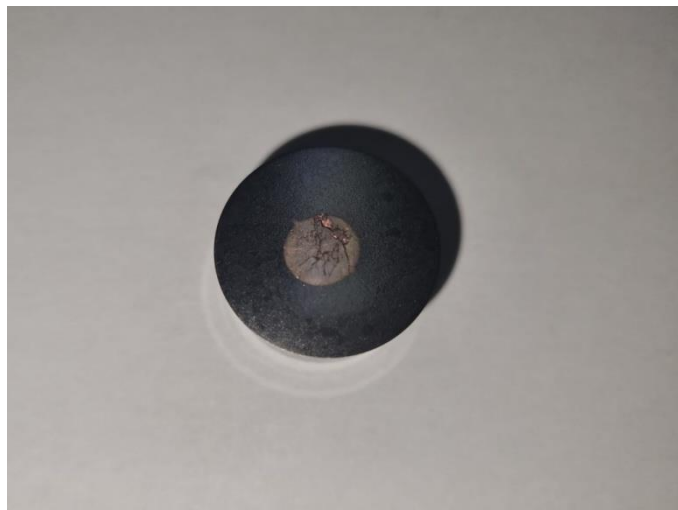
Slika 9. Uzorak 50Cu-50Zr legure nakon nagrivanja
