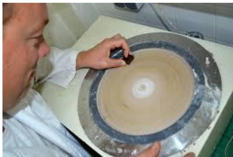
Slika 16. Poliranje površine metala [25]
