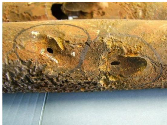
Slika 6. Točkasta korozija [11]
