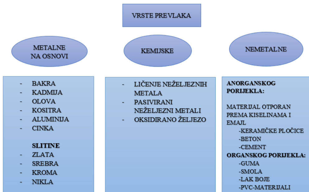
Slika 14. Shematski prikaz podjele prevlaka za površinsku obradu
