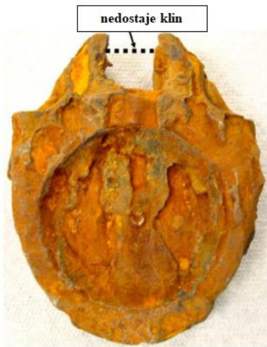
Slika 3. Opća korozija zasuna [8]
