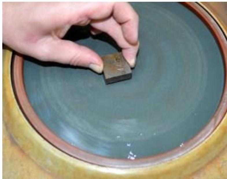
Slika 15. Priprema površine brušenjem [24]
