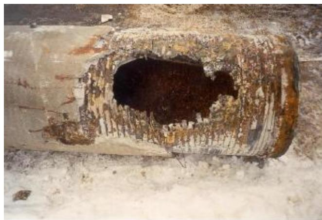
Slika 10. Oštećenja zbog korozije u tlu [14]
