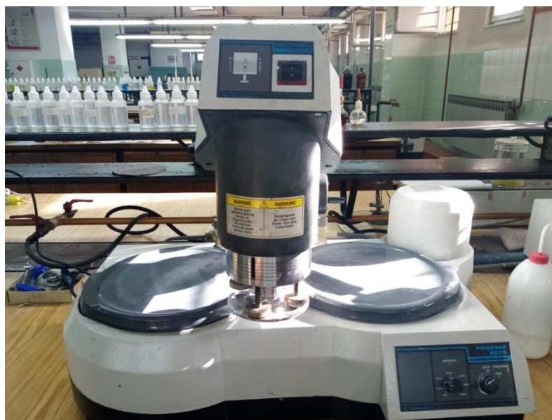
Slika 21. Automatski uređaj za brušenje i poliranje (Büehler)
