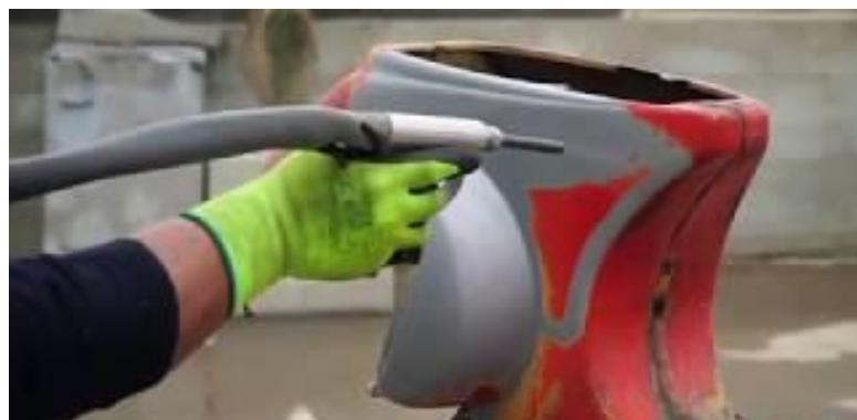
Slika 17. Uklanjanje nečistoća mlazom abraziva [26]
