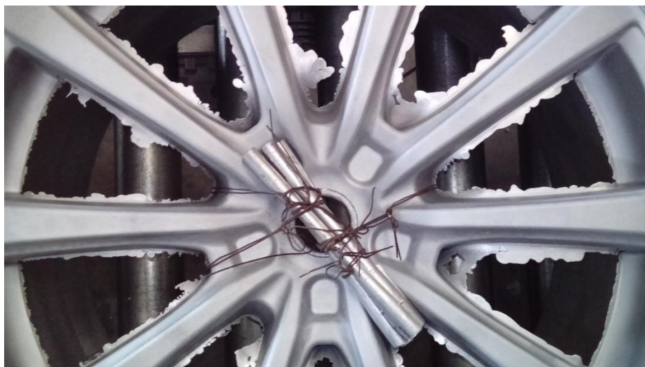
Slika 49. Naplatak i uzorci iz kokile za toplinsku obradu
