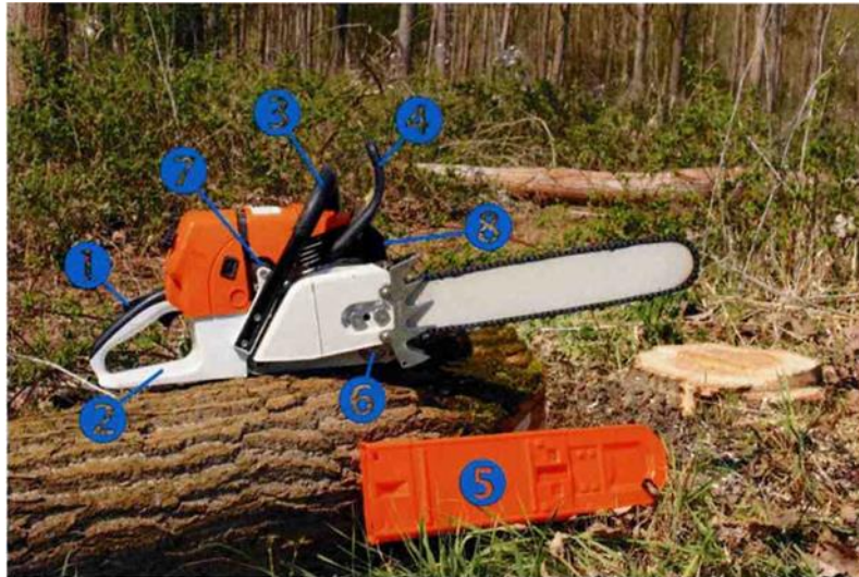
Slika 6. Zaštitne naprave na motornoj pili [6]
