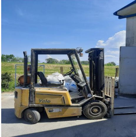
Slika 8. Plinski viličar za manipulaciju teretima u skladištu
