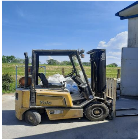
Slika 8. Plinski viličar za manipulaciju teretima u skladištu
