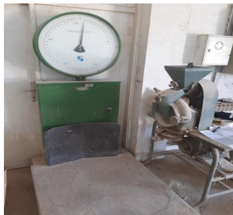
Slika 7. Vaga za vaganje gotovog proizvoda, pakiranja vreća premiksa
