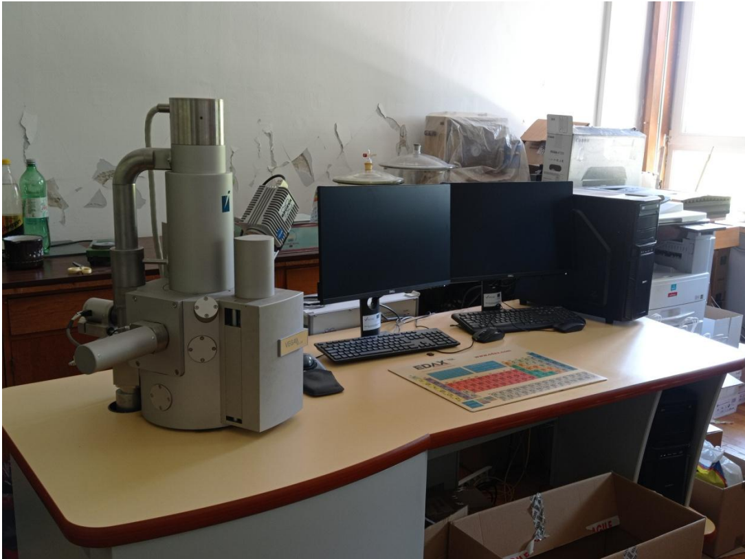
Slika 12. Pretražni elektronski mikroskop TESCAN VEGA 5136 MM
