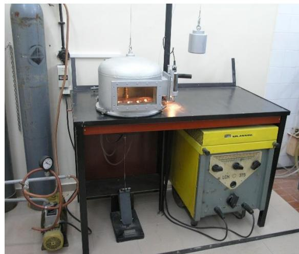
Slika 5. Laboratorijska elektrolučna peć na Metalurškom fakultetu [11]
