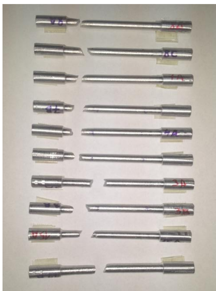
Slika 40. Epruvete nakon statičkog vlačnog ispitivanja
