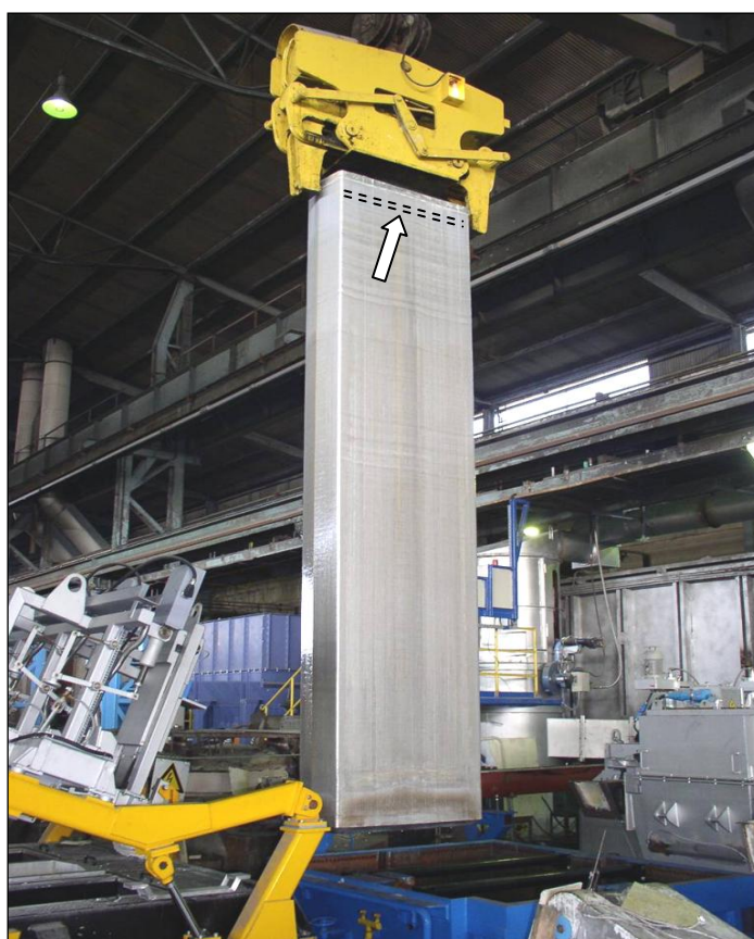
Slika 30. Lijevani blok legure EN AW-5754 izliven na rekonstruiranoj i moderniziranoj liniji za lijevanje blokova s naznačenim mjestom uzimanja ploče (s kraja lijevanja)
