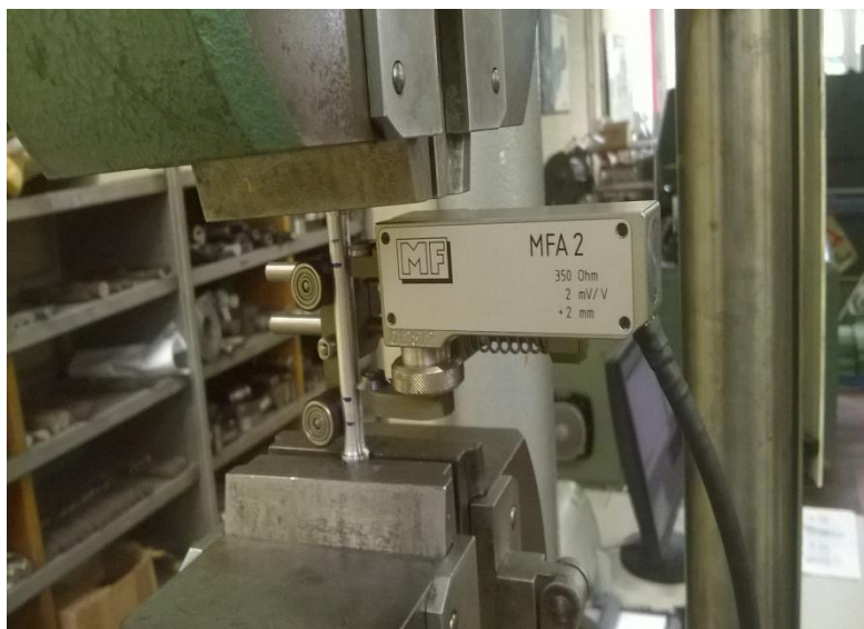
Slika 42. Električni ekstenzimetar na prednapregnutoj aluminijskoj epruveti
