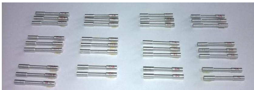
Slika 39. Okrugle epruvete za vlačna ispitivanja
