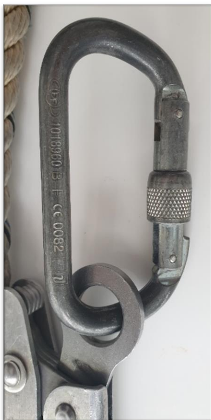
Slika 18. Spojni element tzv. Karabiner s maticom
