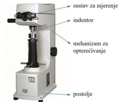
Slika 14. Tvrdomjer i njegove komponente
