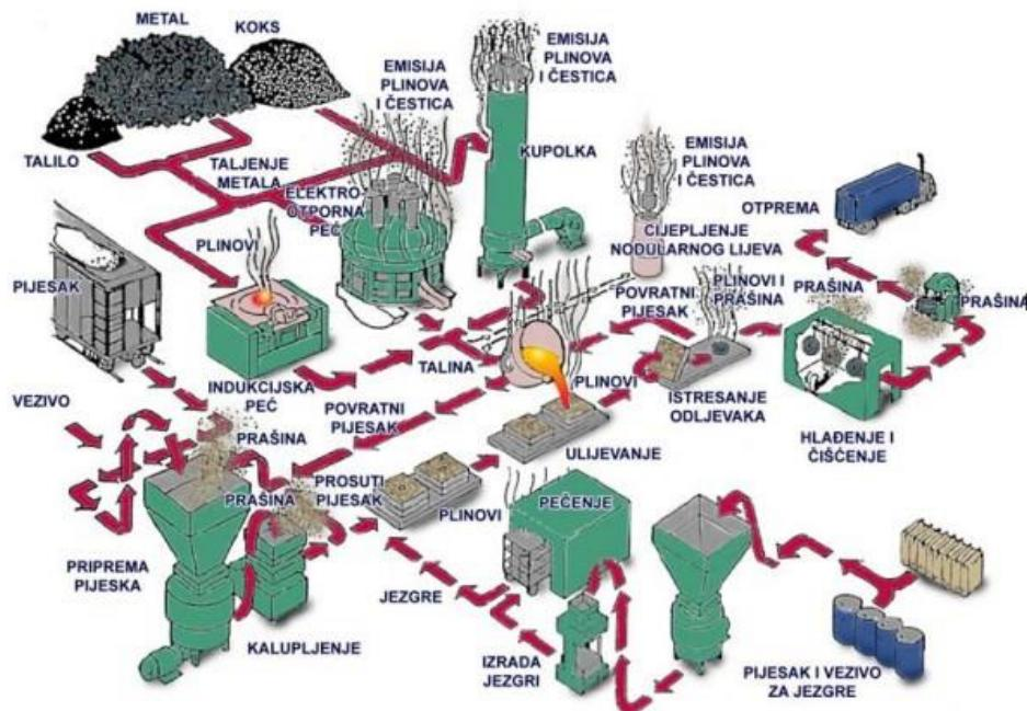
Slika 3. Shematski prikaz procesa u ljevaonicama [14]
