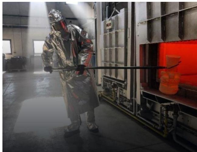
Slika 8. Osobna zaštitna oprema ljevača - aluminizirano odijelo [18]
