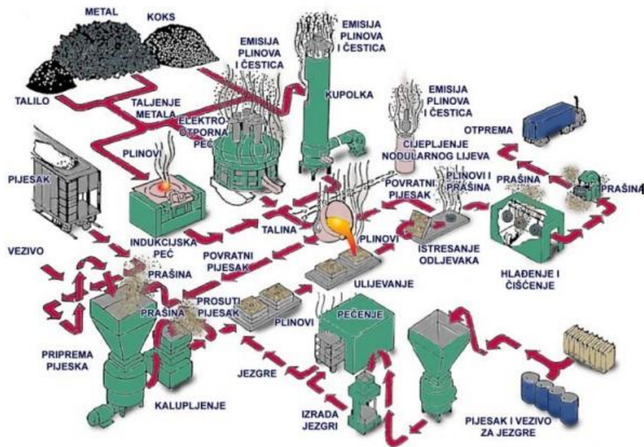
Slika 3. Shematski prikaz procesa u ljevaonicama [14]
