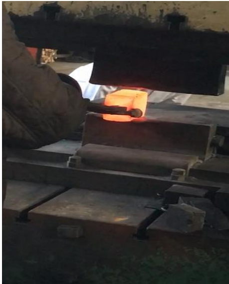
Slika 28. Fotografski snimak ingota tijekom kovanja na hidrauličkoj preši
