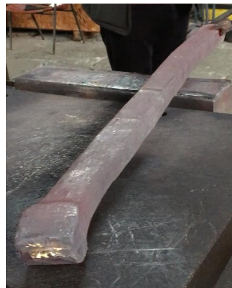
Slika 29. Fotografski snimak ingota tijekom i nakon kovanja na hidrauličkoj preši
