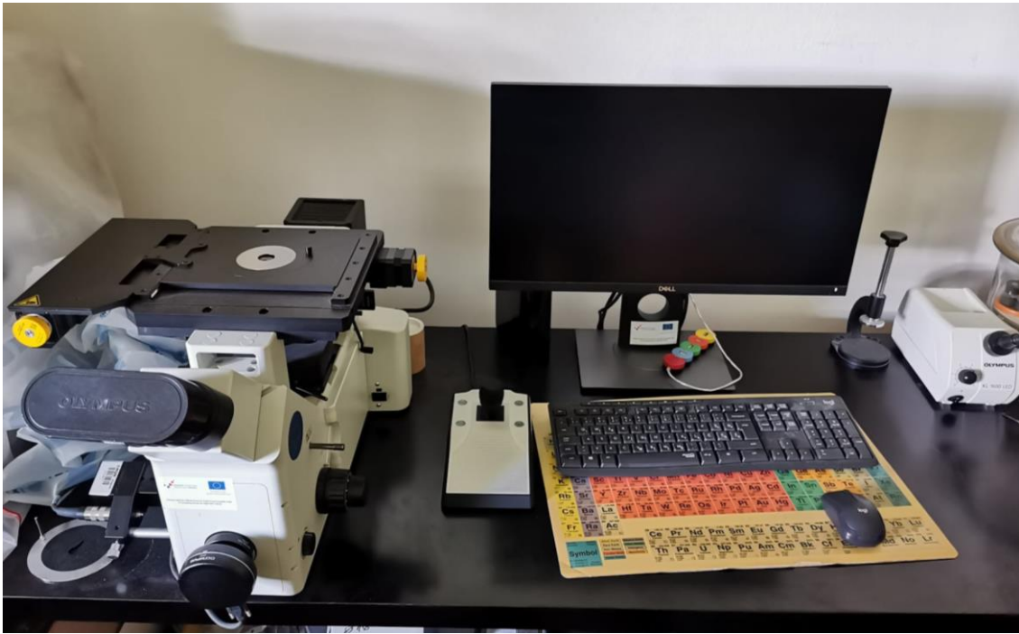
Slika 32. Fotografski snimak svjetlosnog mikroskopa Olympus GX51
