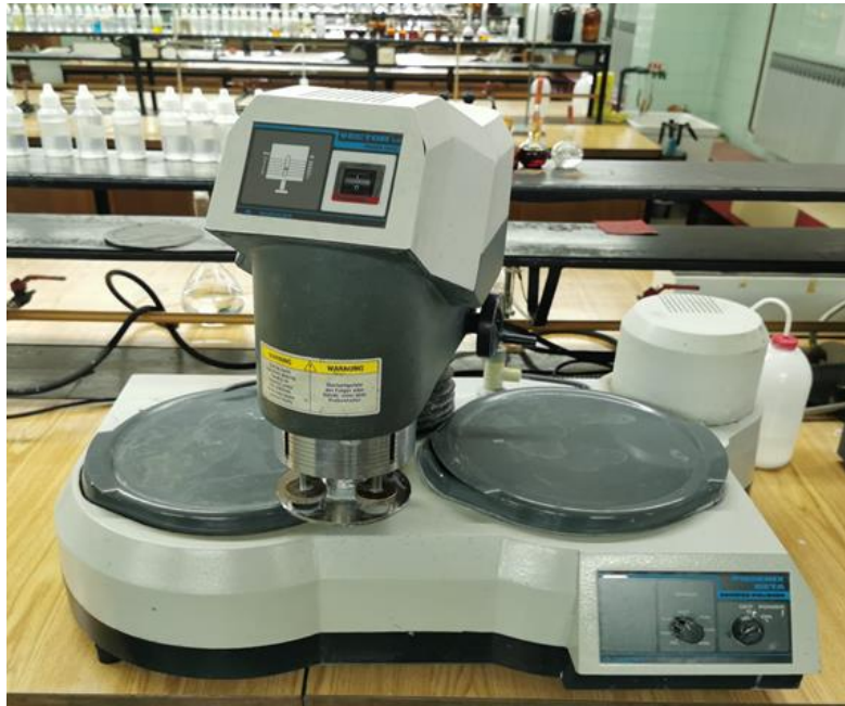
Slika 31. Fotografski snimak uređaja za brušenje i poliranje, Buheler Phoenix Beta
