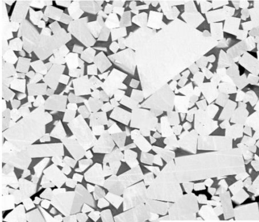
Slika 7.1. - Mikrostruktura WC/Co tvrdog metala [23]
