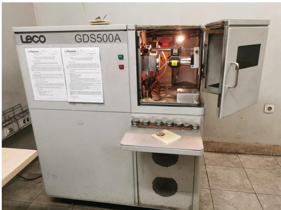
Slika 28. Optički spektrometar Leco GDS500A
