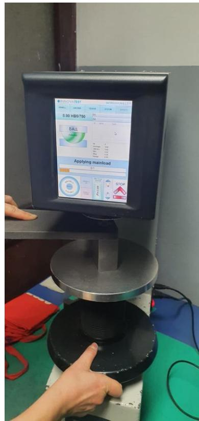
Slika 30. Prikaz ispitivanja tvrdoće na uređaju Inovatest
