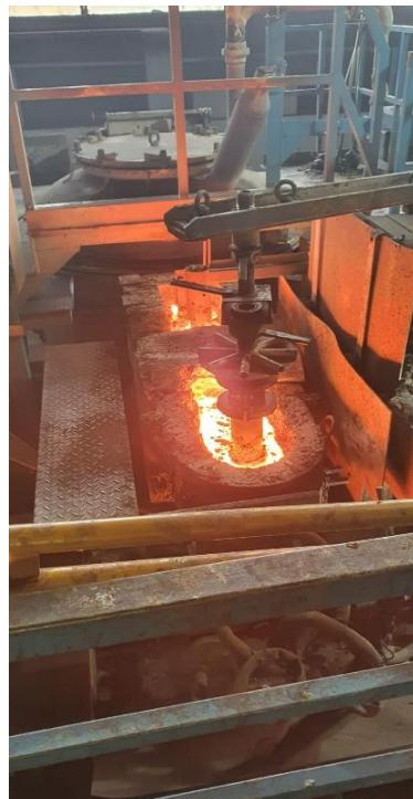
Slika 13. Kanalna peć za lijevanje (Junker)
