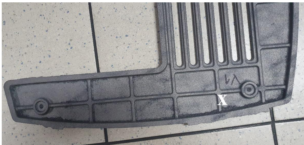
Slika 23. Prikaz zapečenosti u donjem dijelu odljevka
