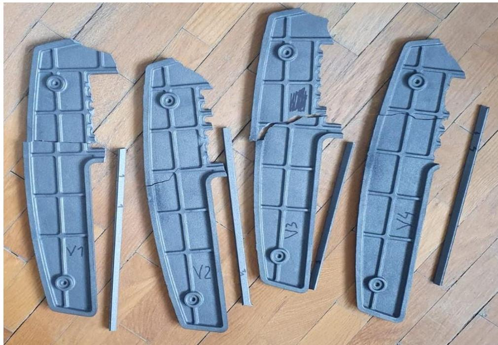
Slika 52. Gornji dio odljevka za ispitivanje i uzorkovanje
