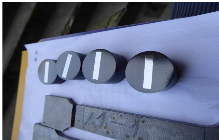
Slika 35. Uzorci V1, V2, V3, V4 u grafitnoj vodljivoj masi
