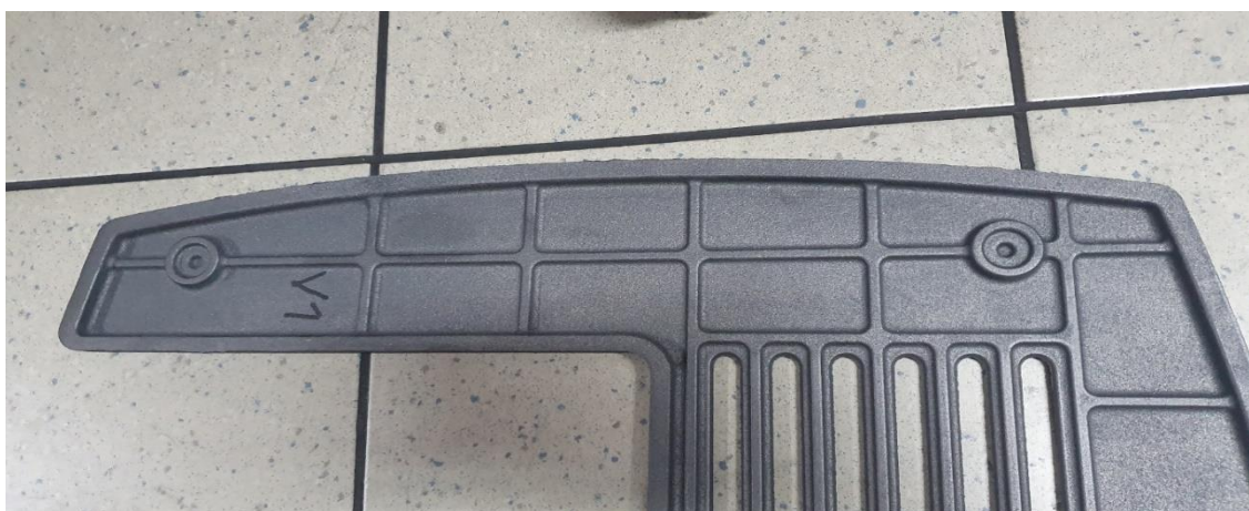
Slika 24. Prikaz gornjeg dijela odljevka
