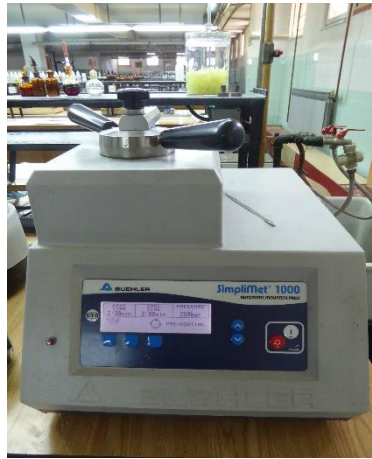
Slika 34. Uređaj za vruće ulaganje uzoraka SimpliMet 1000
