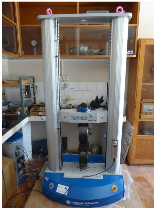
Slika 32. Kidalica HP inspekt table 100kN
