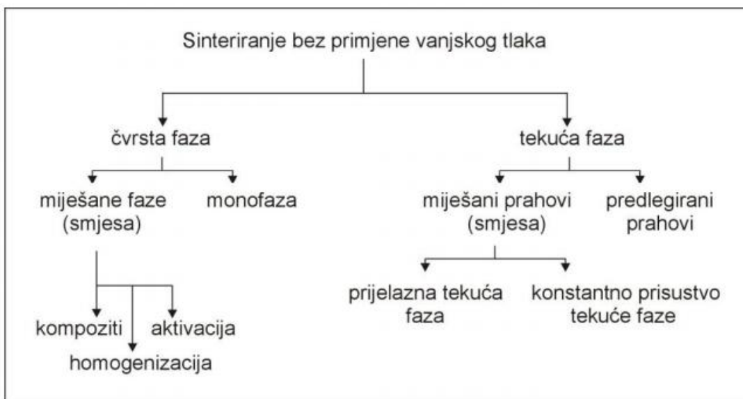
Slika 4.5. Shematski prikaz podjele sinteriranja bez utjecaja vanjskog tlaka [6]
