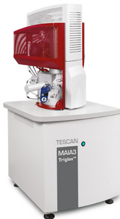
Slika 20. Pretražni elektronski mikroskop MAIA3 (Tescan; Republika Češka) [43]
