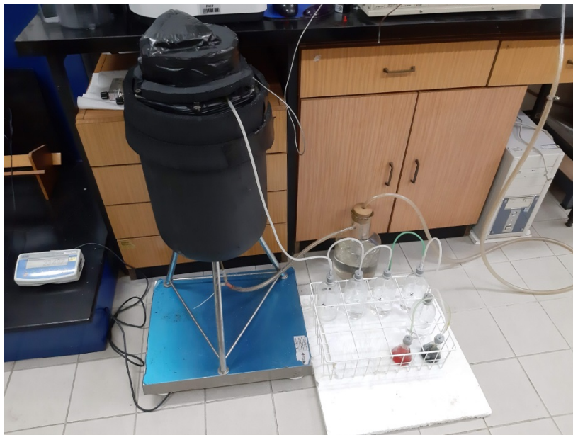
Slika 21. Fotografiska snimka reaktora za kompostiranje (FKIT)
