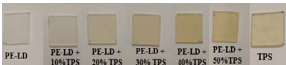
Slika 18. Dobiveni uzorci polimernih PE-LD/TPS mješavina
