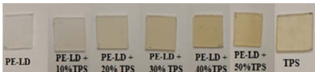
Slika 18. Dobiveni uzorci polimernih PE-LD/TPS mješavina
