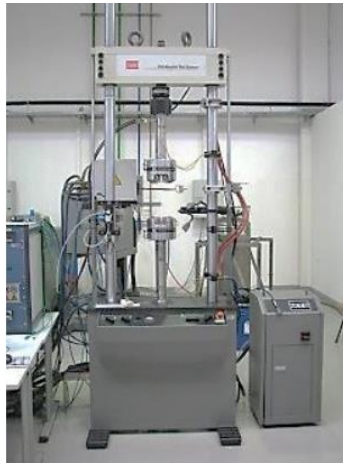
Slika 36. Uređaj za ispitivanje materijala MTS 810
