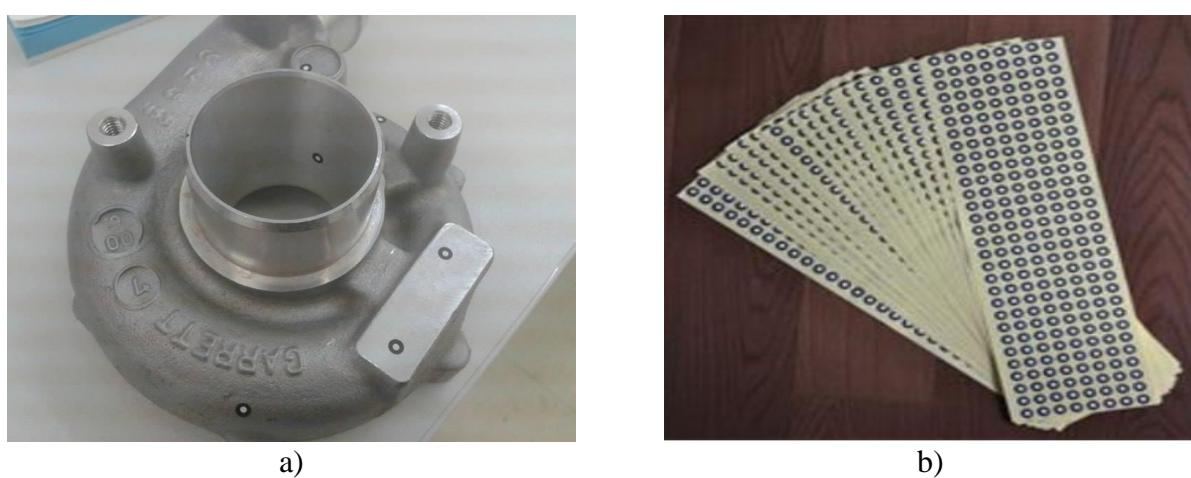
Slika 14. a) Priprema analiziranog objekta za skeniranje, označavanje pojedinih stijenki referentnim točkama, b) Referentne točke u obliku naljepnica
