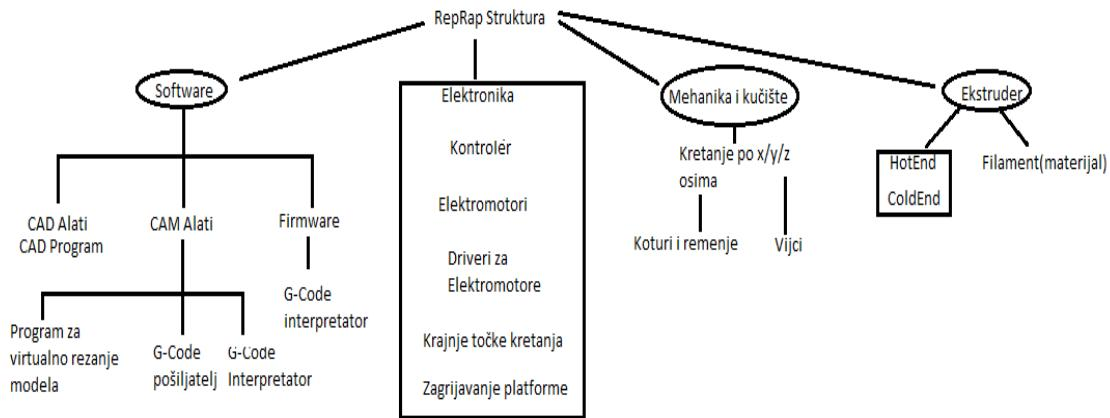
Slika 10. Arhitektura RepRapovog printerja i njemu sličnih printerja [16].
