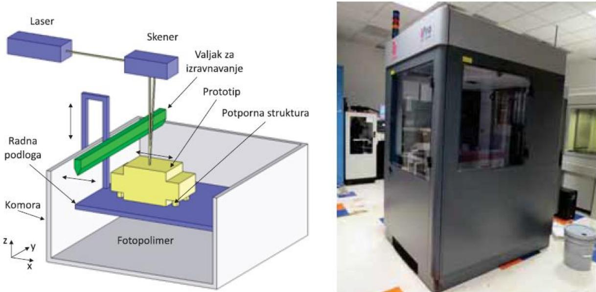
Slika 2. Shematski prikaz uređaja za AM tehnologiju postupkom stereolitografije [3]
