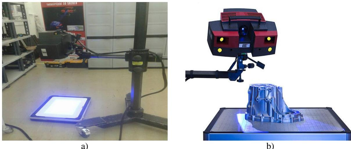
Slika 13. a) Kalibracija skenera i kalibracijska ploča; b) Pogled na prednji dio skenera namješten na stativ – skener marke Atos triple III scan [21]
