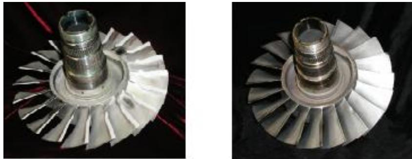
Slika 7.:a) oštećenje turbine uzrokovanu korozijom; b) popravak turbine LENS postupkom [9]
