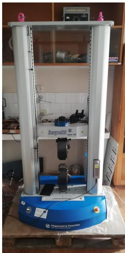
Slika 11. Univerzalni uređaj za ispitivanje vlačnih svojstava, kidalica
