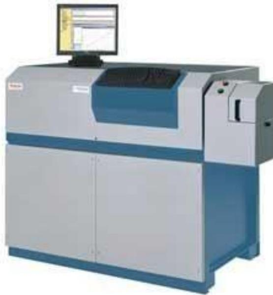
Slika 12. Optički emisijski spektrometar ARL 3460 [24]
