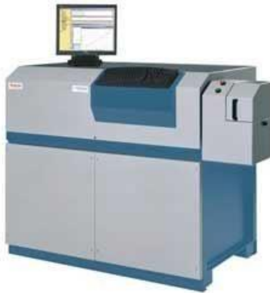
Slika 12. Optički emisijski spektrometar ARL 3460 [24]
