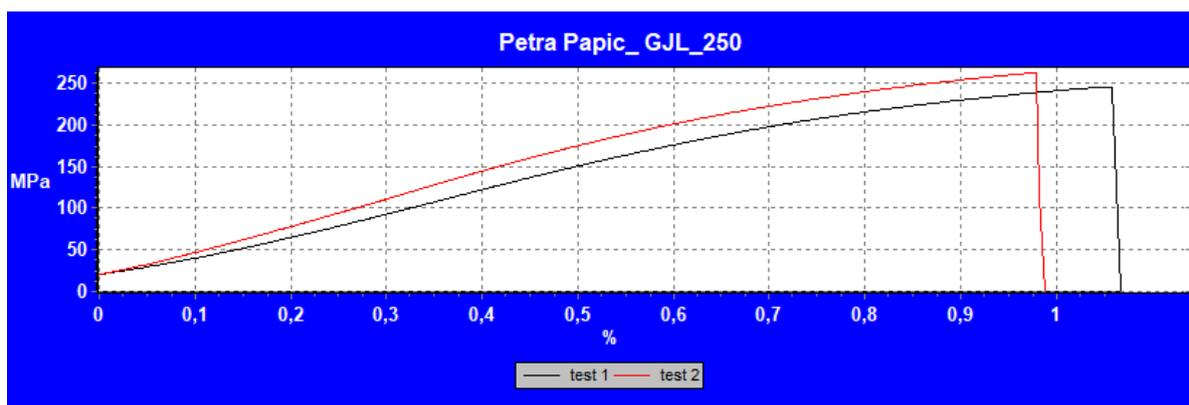
Slika 21. Snimljeni dijagrami naprezanje - istezanje pri ispitivanju EN-GJL-250
