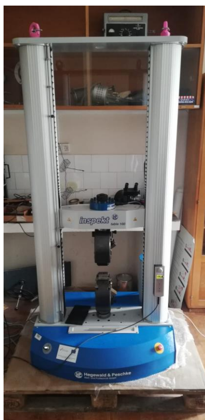
Slika 11. Univerzalni uređaj za ispitivanje vlačnih svojstava, kidalica
