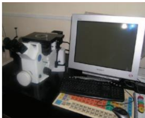
Slika 19. Metalografski mikroskop Olympus GX 51 s digitalnom kamerom DP 70
