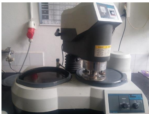
Slika 17. Uređaj za brušenje i poliranje Vektor LC Buehler Phoenix
