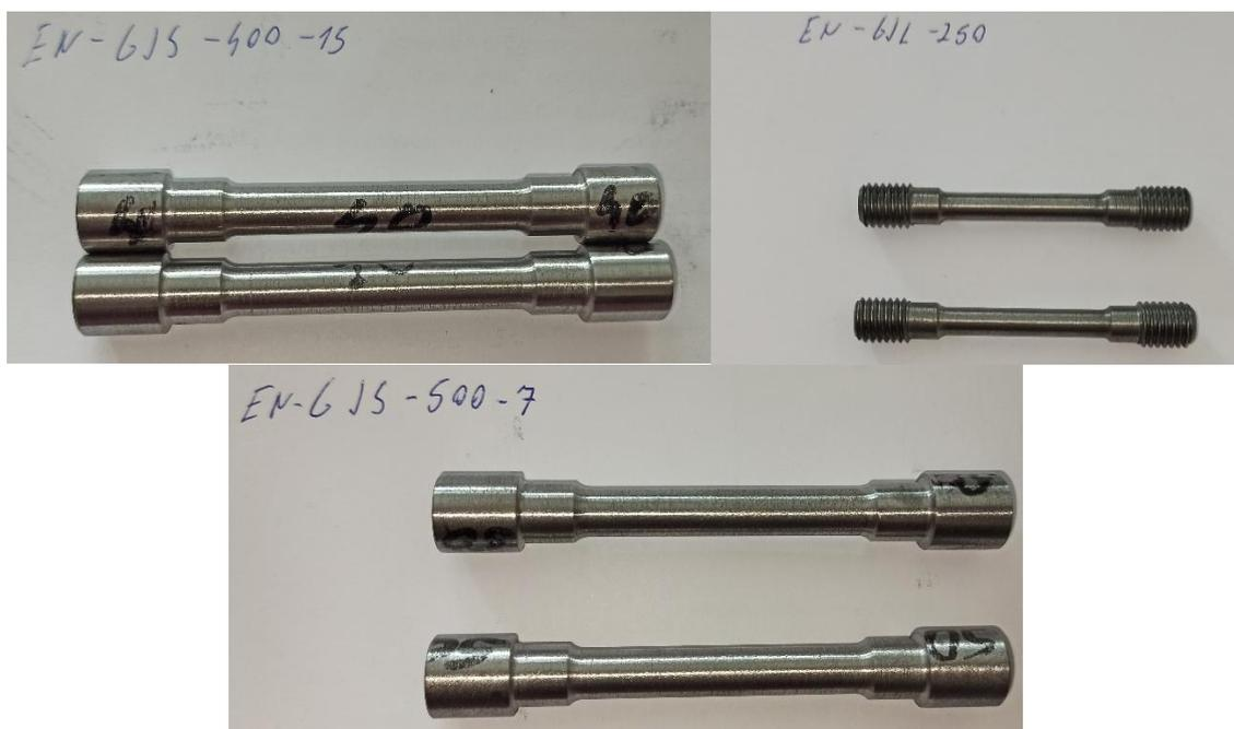
Slika 14. Uzorci za statički vlačni pokus prije ispitivanja
