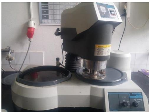
Slika 17. Uređaj za brušenje i poliranje Vektor LC Buehler Phoenix
