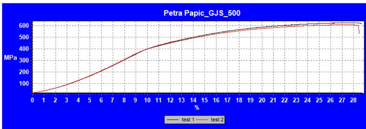
Slika 23. Snimljeni dijagrami naprezanje - istežanje pri ispitivanju EN-GJS-500-7
