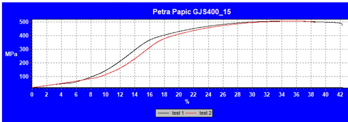
Slika 22. Snimljeni dijagrami naprezanje - istezanje pri ispitivanju EN-GJS-400-15
