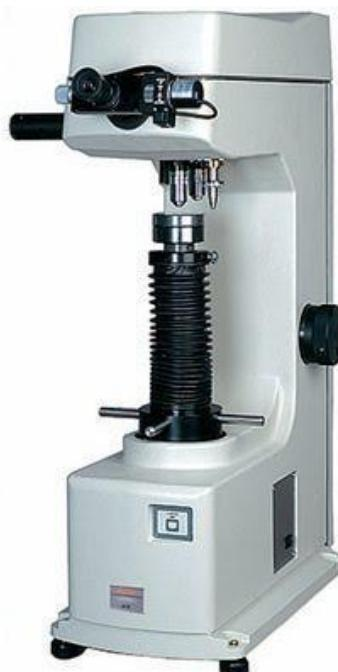
Slika 40. Tvrdomjer *Mitutoyo Hardness Testing Machine HV*
