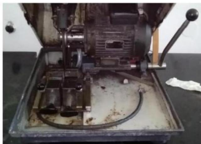
Slika 33. Rezalica Buehler za rezanje uzorka
