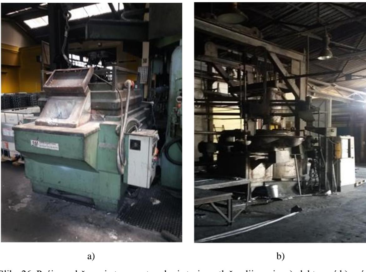
Slika 26. Peći za održavanje temperature kraj stroja za tlačno lijevanje: a) elektropeć b) peć s plinskim plamenikom
