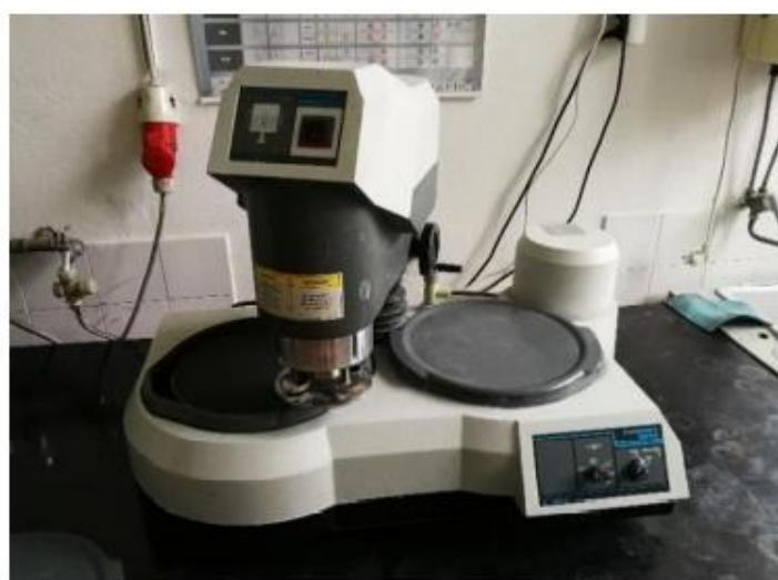
Slika 35. Uredaj Buehler za brušenje i poliranje uzoraka
