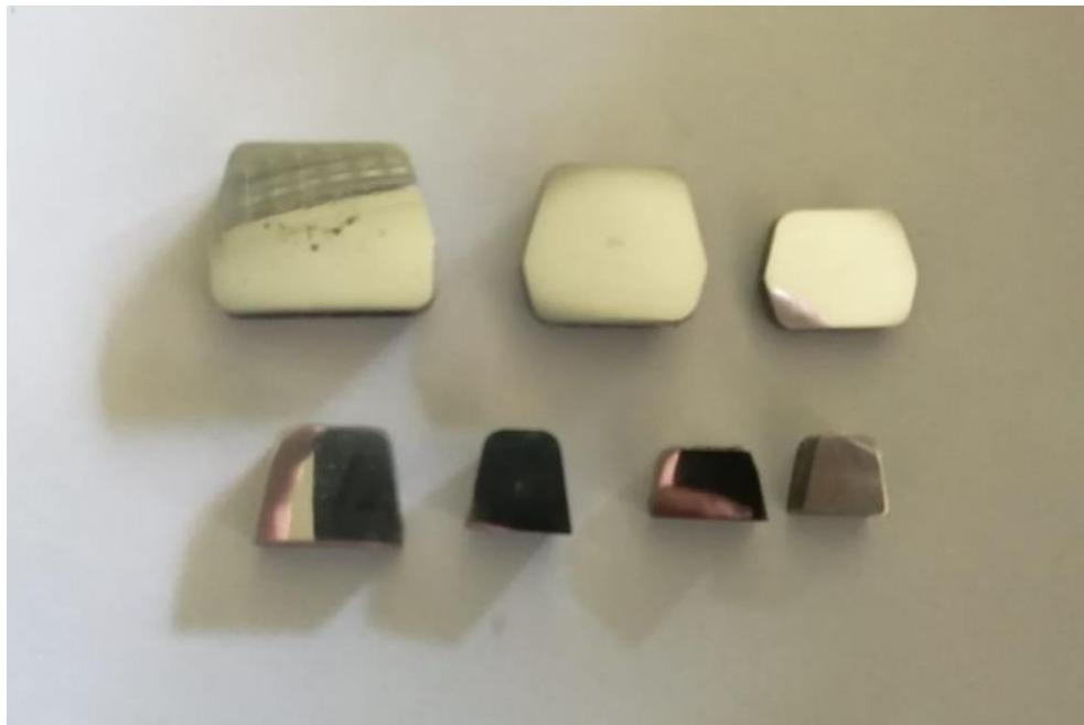
Slika 36. AlSi12 uzorci za metalografska ispitivanja
