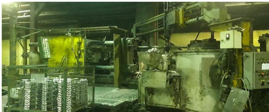
Slika 28. Stroj za visokotlačno lijevanje
