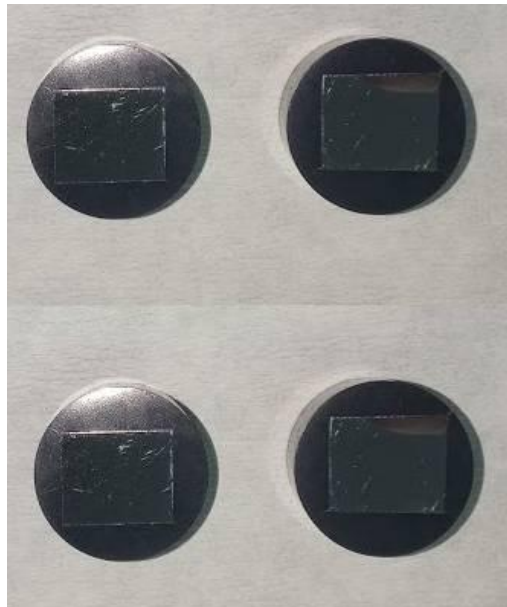
Slika 24. Uzorci alatnog elika X19NiCrMo4 prije ispitivanja
