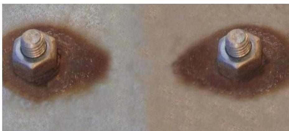
Slika 11. Primjer galvanske korozije, spoj vijka i matice [18]
