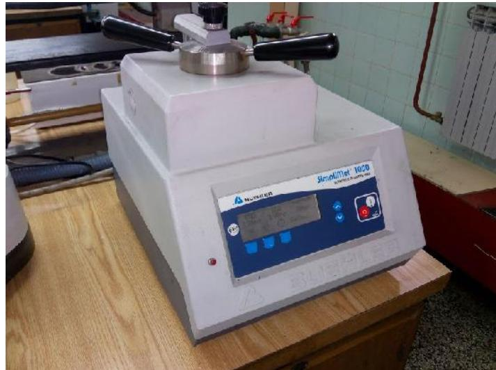
Slika 30. Uređaj za ulaganje uzorka u ugliknu masu postupkom vrućeg prešanja, SimpliMet® 1000
