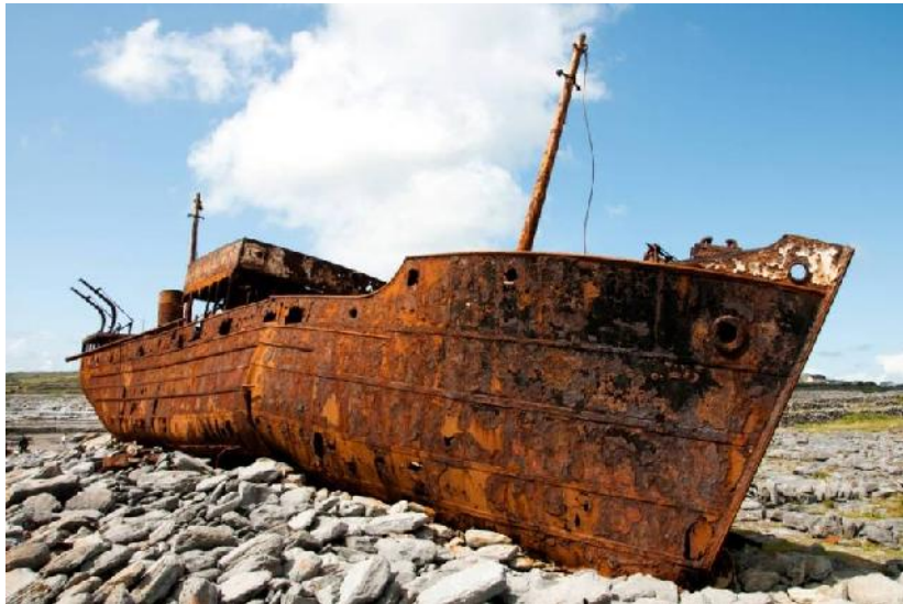
Slika 5. Primjer op e korozije, površina broda [15]
