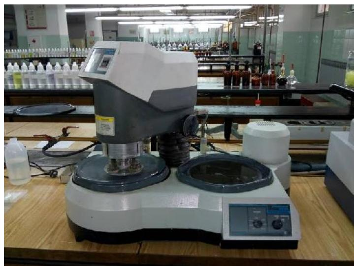
Slika 31. Automatski uređaj za brušenje i poliranje, Büehler
