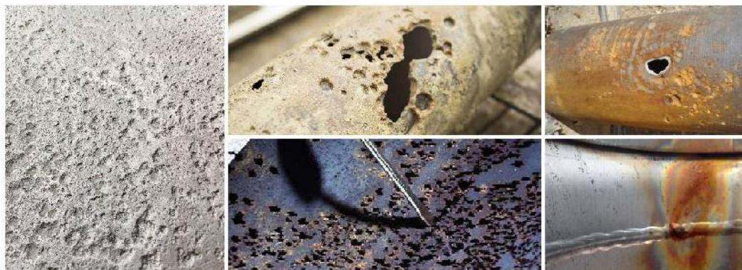
Slika 10. Primjeri rupiaste korozije na cijevima, ravnim metalnim površinama te na zavarenim spojevima [17]
