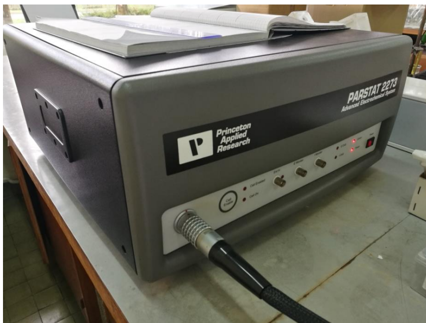
Slika 24. Računalom upravljani potenciostat/galvanostat Parstat 2273
