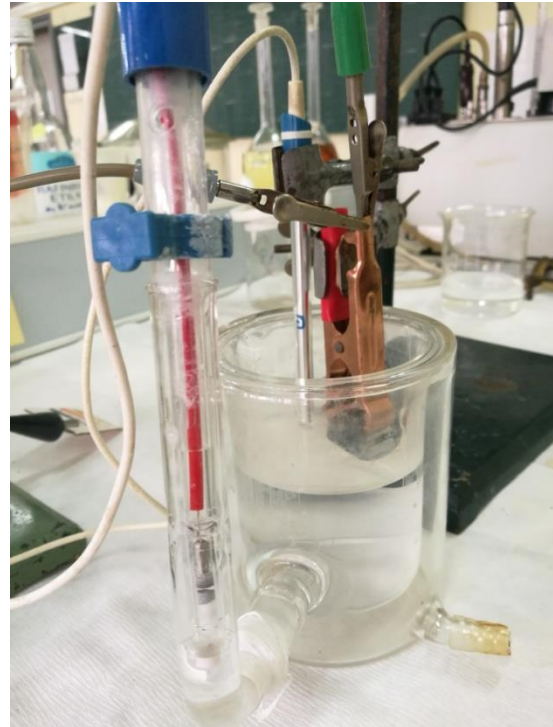
Slika 23. Troelektrodna staklena ćelija za elektrokemijska mjerenja
