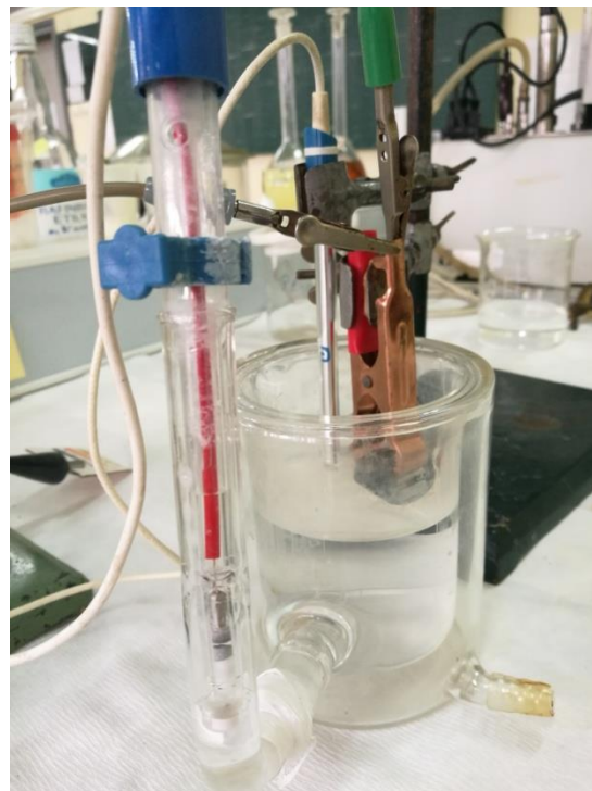
Slika 23. Troelektrodna staklena ćelija za elektrokemijska mjerenja
