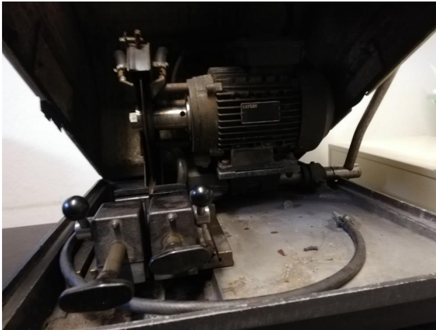
Slika 35. Uređaj za rezanje uzoraka "Buehler Isomet"
