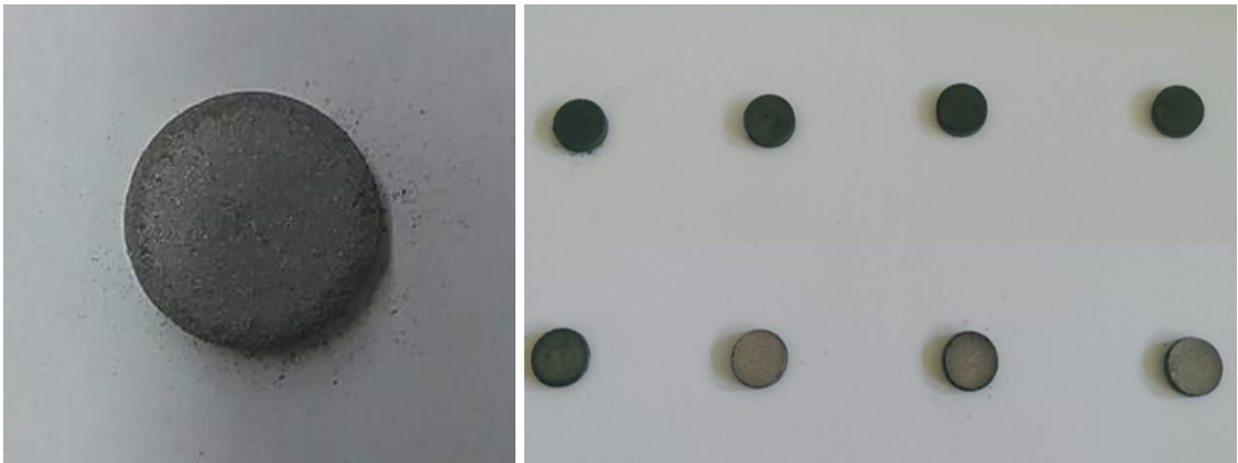
Slika 13. Otpresci Ti-20Zr legure
