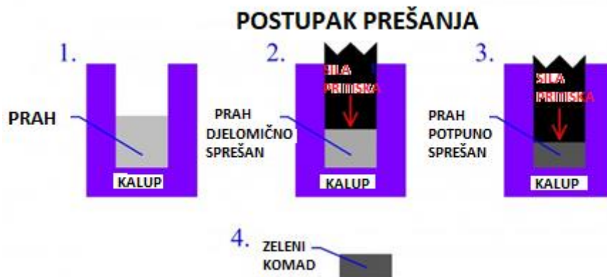
Slika 9. Postupak prešanja [23]
